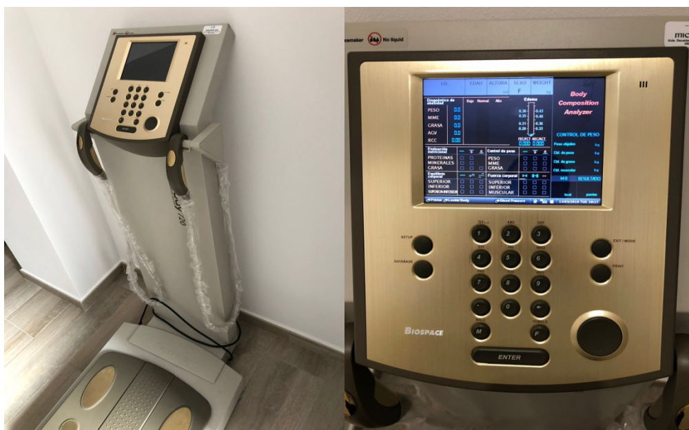
Figura 1: analizador de impedancia bioeléctrica InBody 720 (Biospace Co., Ltd; Seúl, Corea)
