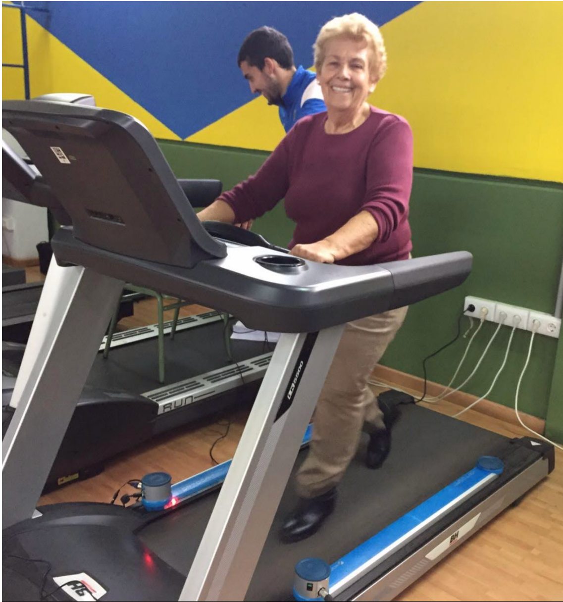
Figura 2: Una participante realizando la prueba de análisis de la marcha OptoGait (Microgate Italy, Bolzano-Bozen, Italia)
