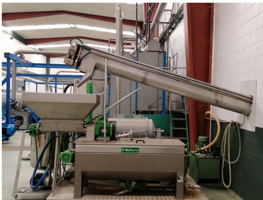
Figura 4.12 – Vista lateral do extrator centrífugo Il Molinetto
