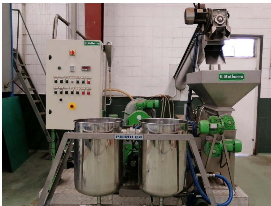
Figura 4.11 – Vista frontal do extrator centrífugo Il Molinetto
