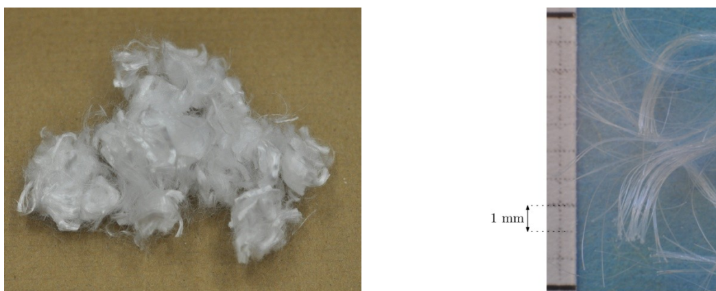
Figura 4: Fibras de polipropileno empleadas como refuerzo y detalle de los extremos de las fibras.
