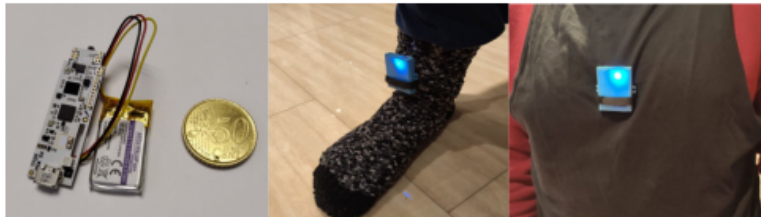
FIGURA 5.2: Tactigon ONE: izquierda), sensor inercial integrado en la placa; centro y derecha), Tactigon adherido a los calcetines y la camiseta del paciente, respectivamente.
