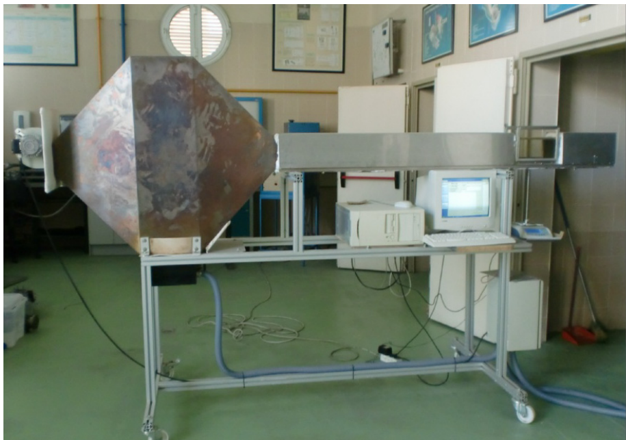
Figura 3.1 Equipo experimental para la realización de los estudios de la cinética de secado.
