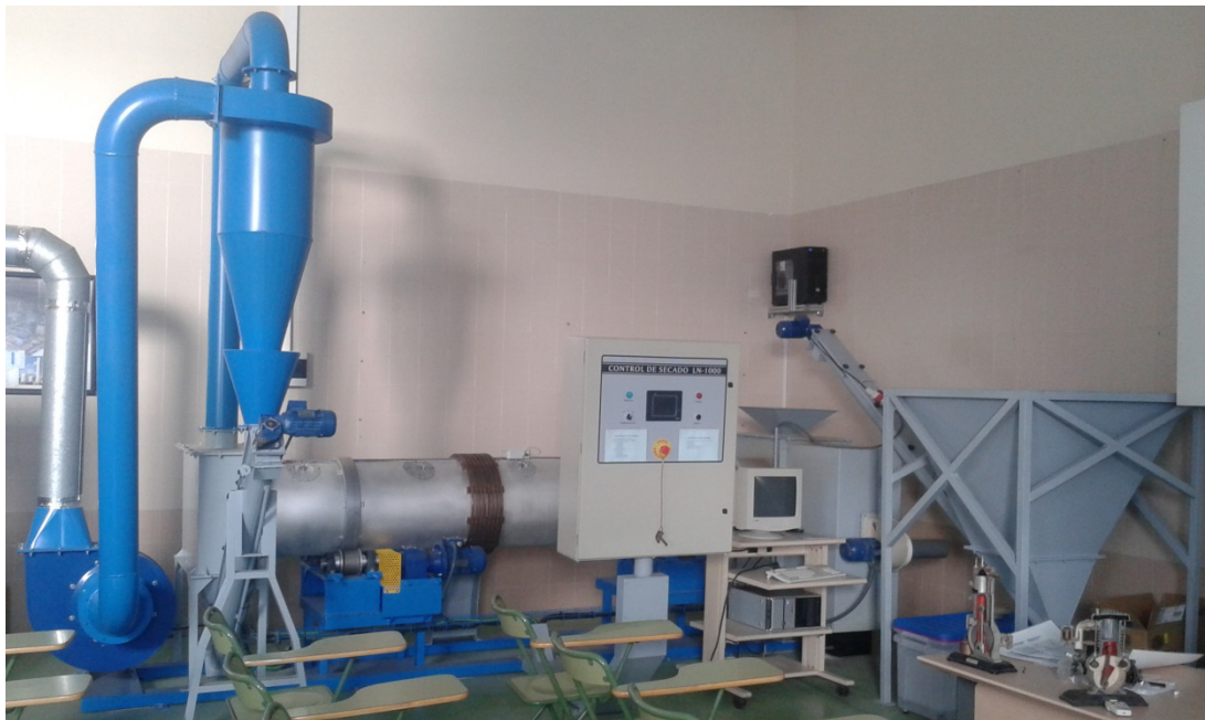
Figura 6.1 Secadero rotativo experimental para el secado de subproductos de almazara.
