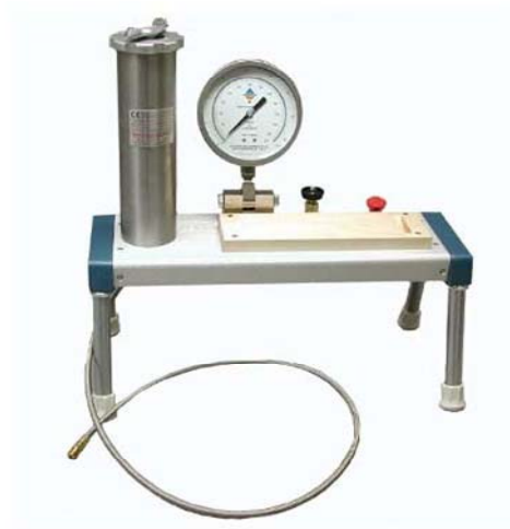
Figura II.7. El modelo de sobremesa empleado. Obsérvese la cámara metálica, el manómetro, la entrada de gas y distintas válvulas.
