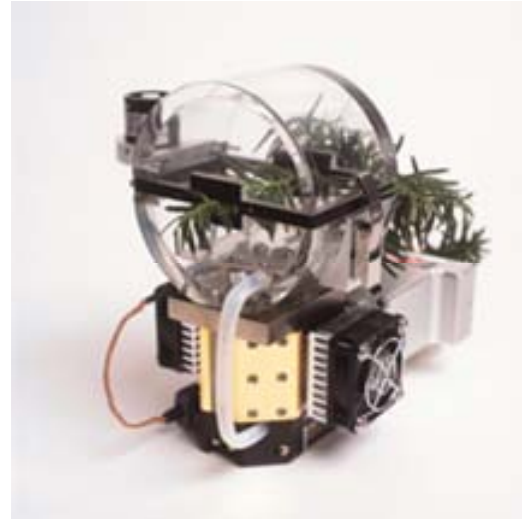
Figura II.9. Cámara de coníferas modelo LI – 6400 - 05 empleada con el IRGA LI - 6400. El cilindro negro de la parte izquierda es el sensor externo de PAR incidente..
