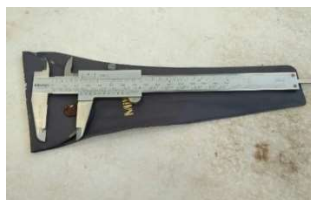
Figura 36. Calibre de precisión \pm 0,05 mm para el dimensionado de las piezas cerámicas.
