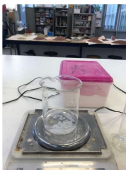
Figura 47. Mezcla y agitación de la fase líquida-activador alcalino.
