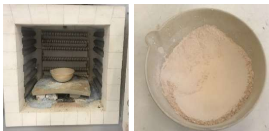
Figura 21. Calcinación del caolín a 750 °C obteniendo metacaolín.
