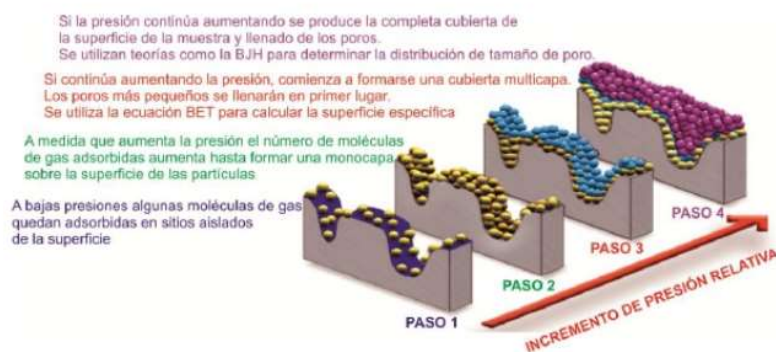
Figura 43. Esquema del análisis por fisisorción de nitrógeno.
