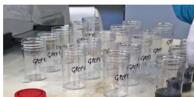
Figura 49. Moldes cilíndrico y relleno de la pasta.
