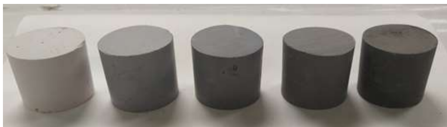
Figura 61. Los geopolímeros obtenidos, de izquierda a derecha (porcentajes en peso) 0 % OPBA, 25 % OPBA, 50 % OPBA, 75 % OPBA, 100 %OPBA.
