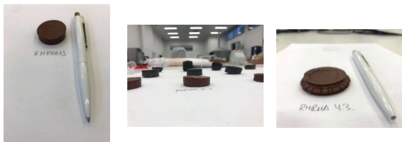
Figura 53. Muestras de geopolímeros de cascarilla de arroz con lodo rojo antes y después del ensayo de resistencia a compresión.
