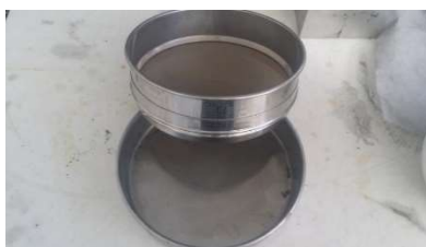
Figura 23. Tamiz de acero inoxidable de luz 0,1 mm de la marca Filtra.
