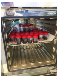
Figura 50. Proceso de secado en estufa a 75 °C durante 24 horas.
