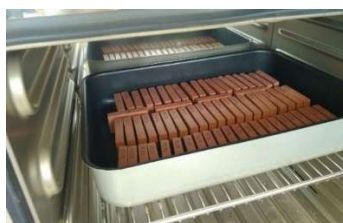
Figura 37. Colocación de las piezas en la estufa a una temperatura de 100°C.
