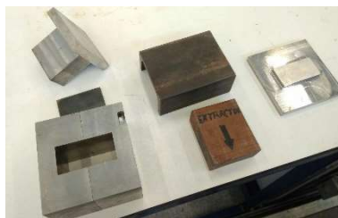
Figura 31. Matriz de 60 mm de longitud x 30 mm de ancho empleados en la prensa hidráulica, destinados al conformado y extracción de la pieza cerámica.
