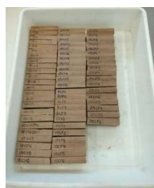
Figura 33. Piezas conformadas en la matriz de aluminio con la prensa hidráulica
