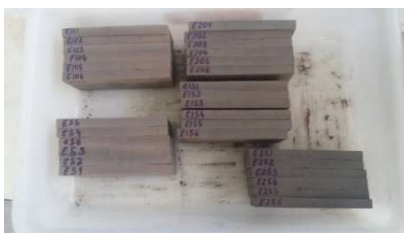
Figura 33. Piezas conformadas en la matriz de aluminio con la prensa hidráulica
