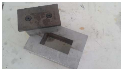
Figura 30. Matriz de aluminio de 100 mm longitud x 50 mm de ancho utilizada en el conformado de las probetas de escoria negra de siderúrgica.
