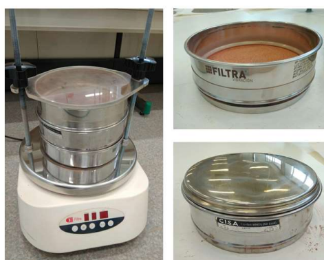
Figura 18. Equipo de tamizado Filtra Vibración® (izquierda) y tamiz de 150 \mu\text{m} de C.I.S.A. (derecha inferior).
