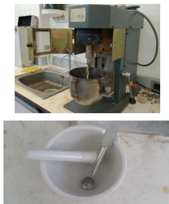
Figura 29. Amasadora estándar para morteros Mecanizados MEF, S.L. ® . (arriba) y mortero de porcelana, y cucharita con raspador de acero inoxidable (abajo)
