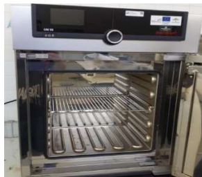
Figura 34. Estufa eléctrica de la marca Memmert de aire ventilado para el secado de las materias primas y las probetas.
