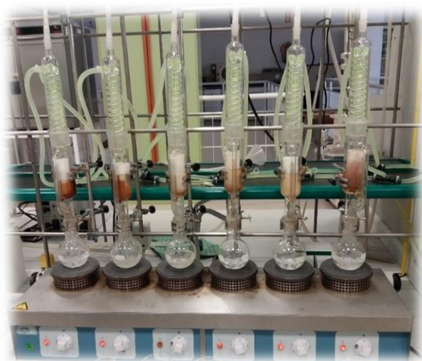
Figura 28. Equipo experimental de extracción Soxhlet. Fuente: Elaboración propia.
