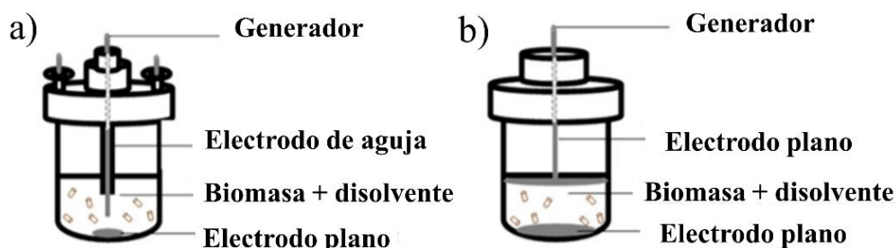
Figura 32. Equipo de campos eléctricos pulsados (a) y descargas eléctricas de alto voltaje (b). Fuente: adaptada de Rajha et al. (2014).
