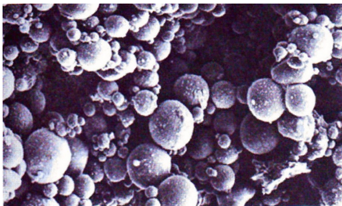
Figura 40. Microfotografía de cenizas volantes de carbón [59].
