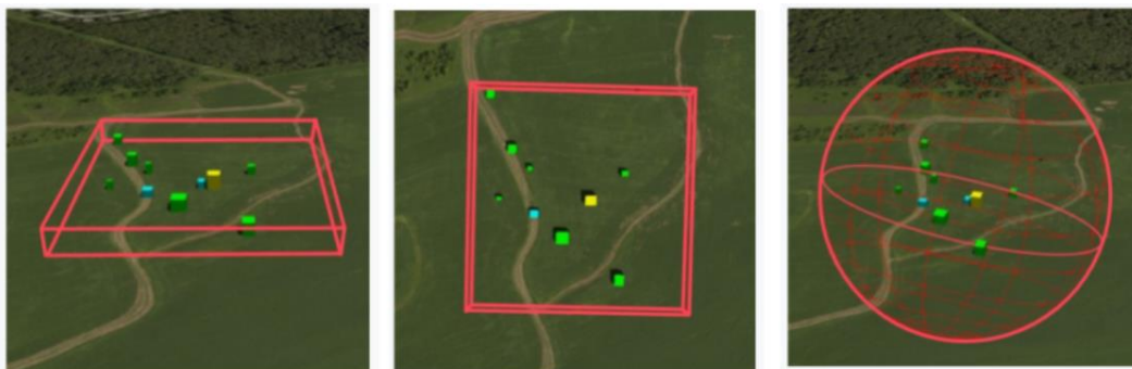
Figura5.2. Representación de instancias BoundingBox de tipos box , region y sphere respectivamente.
