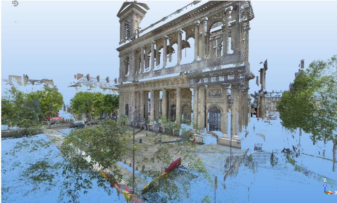
Figura 1.2. Escena escaneada en París usando un Trimble TX8 para el proyecto Terra Mobilitable.
