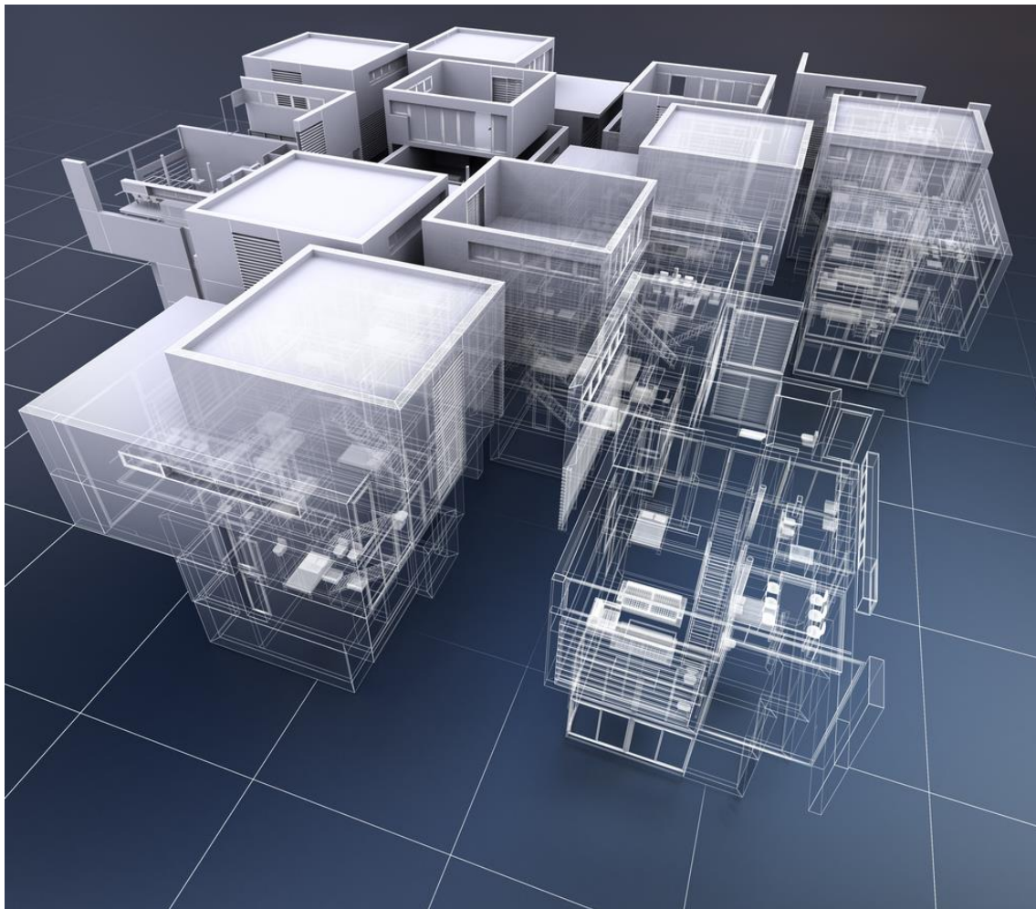
Figura1.3. Mediante el procesoScanto-BIM se pueden crear modelos 3D de una infraestructura o inmueble a partir de nubes de puntos© Shutterstock.
