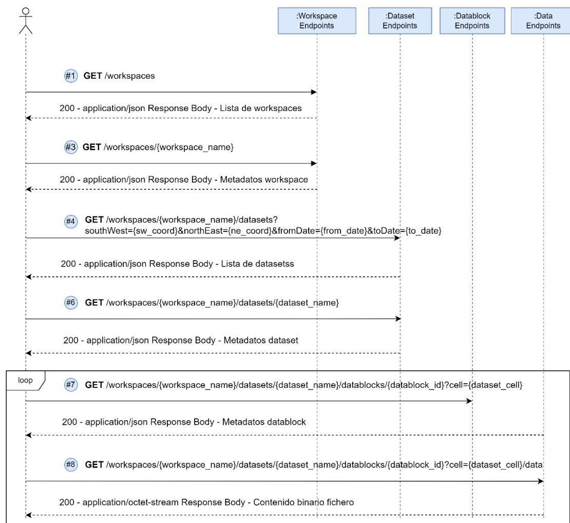
Figura2.7. Diagrama de secuencia con las operaciones para llevar a cabo una consulta de datos.
