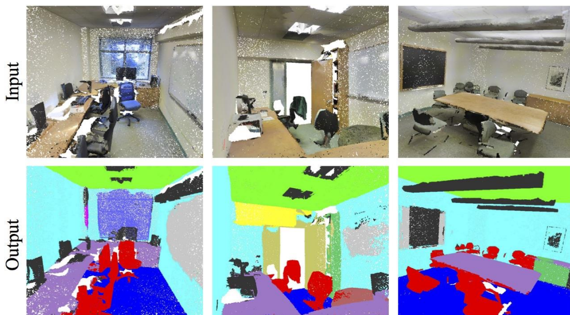
Figura 1.9. Resultado de una segmentación semántica de PointNet (Qi et al., 2017)
