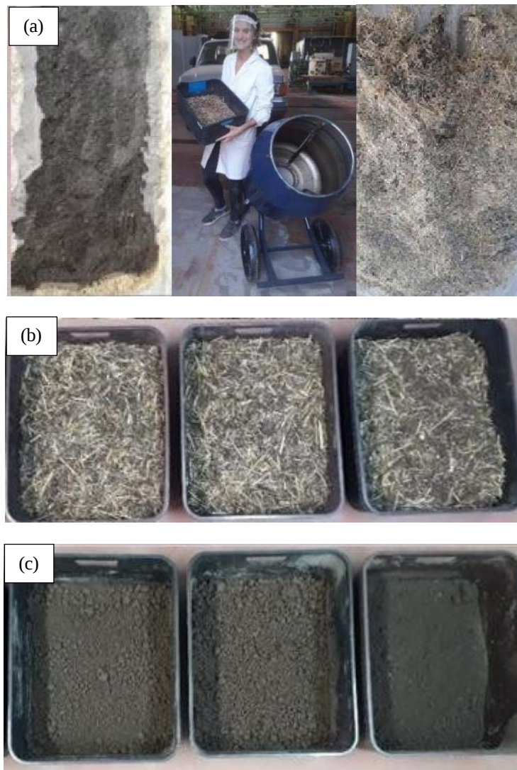
Figura 4. (a) Mezcla de todos los materiales en las proporciones adecuadas para la confección de la biomezcla; (b) Biomezcla a escala de laboratorio (triplicado); (c) Controles de suelo a escala de laboratorio (triplicado).
