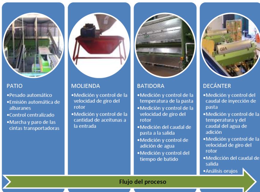
Figure A.1 Posibilidades de automatización de las fases del proceso.
