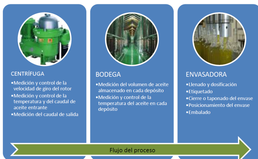
Figure A.2 Posibilidades de automatización de las fases del proceso (continuación).
