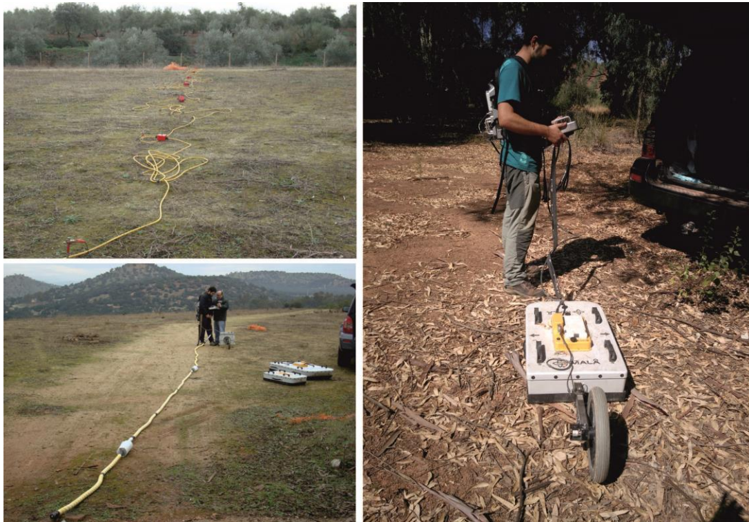
Figura 24. Reportaje fotográfico de la campaña de prospección geofísica. a) Disposición sobre el terreno del perfil de tomografía. b) Antena 250 MHz. c) Antena de 30 MHz
