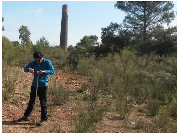
Figura 18. Muestreo alrededor de la fundición de La Cruz con el tornillo tomamuestras “Auger”.
