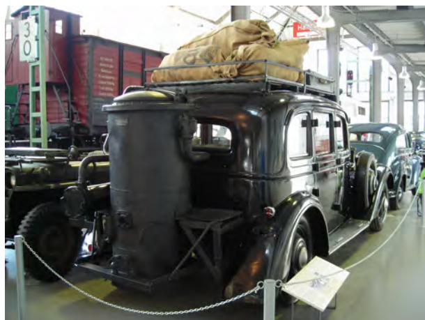
(a) Automóvil alemán equipado en 1941 con un gasógeno de tipo Imbert debido a la escasez de gasolina. El gas pobre impulsa un motor de cuatro tiempos de 6 cilindros en serie (potencia de salida: ~26 kW (36 CV); velocidad máxima: ~70 km/h). En exhibición en el Deutsches Museum de Múnich (Alemania).
