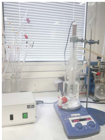
Figura 4.3. Montaje del equipo empleado para llevar a cabo los estudios de degradación UV.
