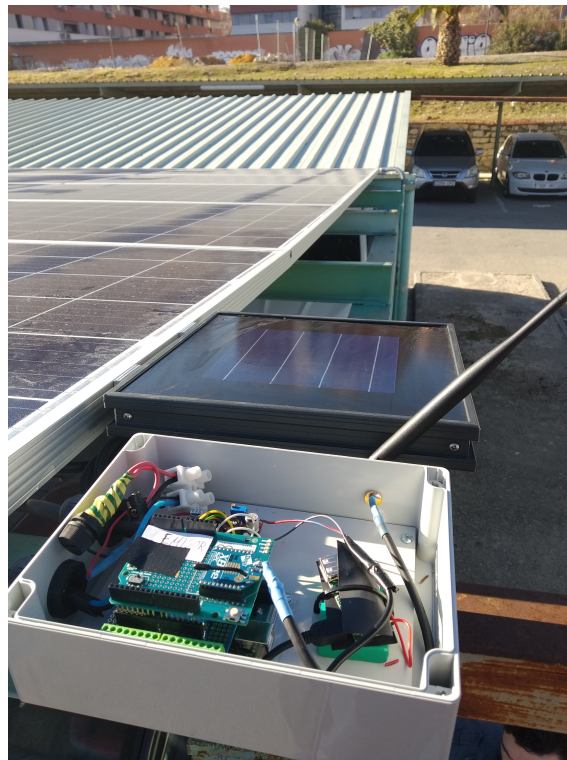
Figura 3.6: Sensores de radiación y temperatura
