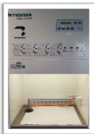
Fig. 4.11. Cabina vertical de flujo laminar
