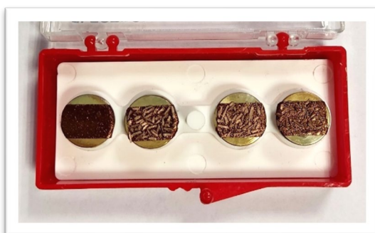
Fig. 4.15. Muestras con metalizado de oro para microscopio electrónico de barrido
