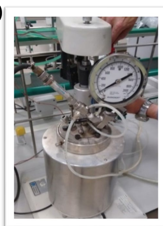
Fig. 4.2. Reactor a presión. a) Vista general del montaje, b) Cuerpo del reactor
