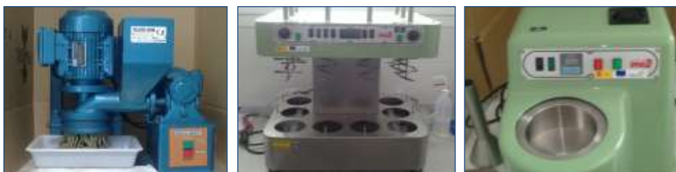
Figura II.6: Sistema Abencor para la extracción de aceite de oliva
