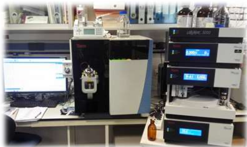
Figura II.32: Equipo LC-Qq utilizado. Cromatógrafo de líquidos Dionex Ultimate 3000 acoplado a un espectrómetro TSQ-Quantiva triple cuadrupolo ( Thermo Scientific )
