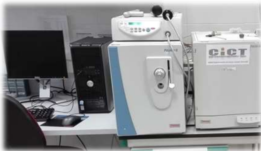
Figura II.33: Instrumento GC-IT. Cromatógrafo Focus GC acoplado a una trampa Polaris Q ( Thermo Scientific ). Recurso de los servicios técnicos de instrumentación (CICT, Universidad de Jaén).
