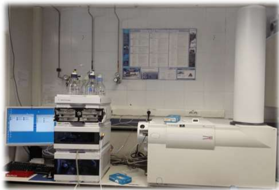
Figura II. 34: Equipo LC-TOF. Cromatógrafo de líquidos Agilent 1290 acoplado a un espectrómetro de tiempo de vuelo Agilent 6220 ( Agilent Technologies )
