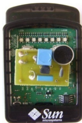
Figura 5.18. SunSPOT con circuito de adquisición de datos integrado.
