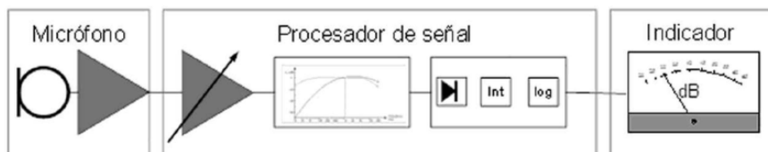
Figura 2.8. Diagrama de bloques funcionales de un sonómetro básico.
