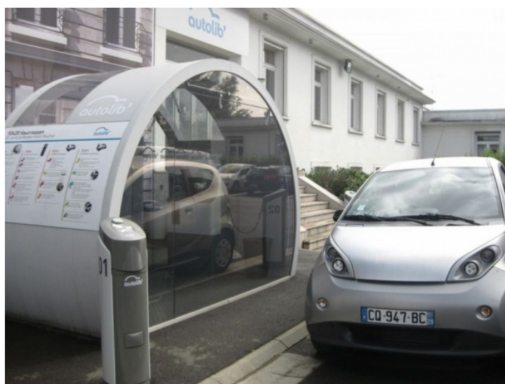
Figura 10. Plaza de aparcamiento con un quiosco de registro, una estación de carga y un Bluecar [48].
