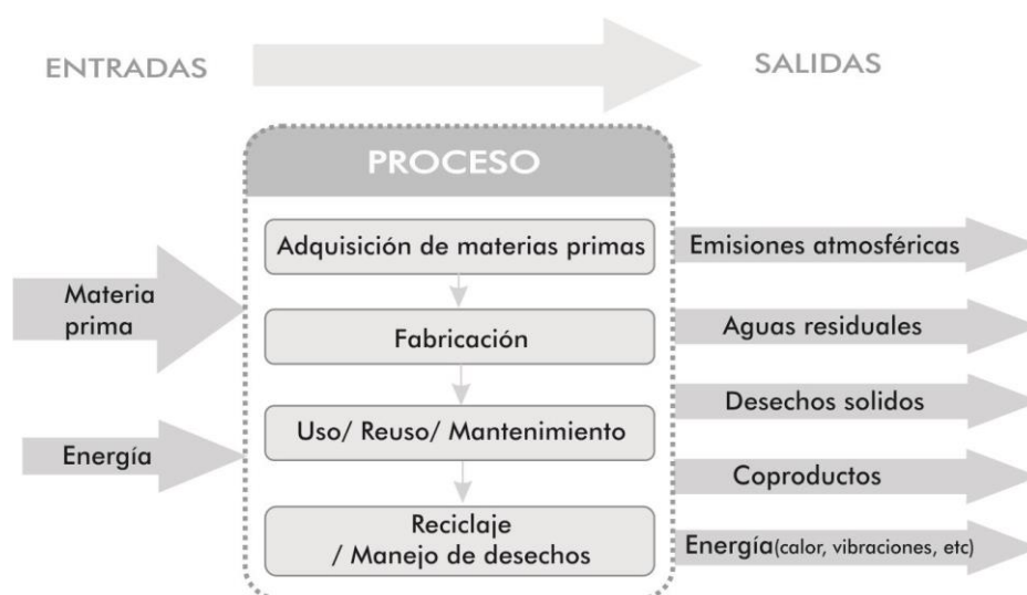
Figura 70. Entradas y salidas relativas al ACV. Fuente: ISO 14000
