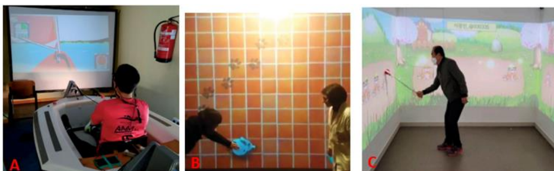
Figura 10. Dispositivos de Realidad Virtual Semi Inmersiva v-Sail Access® (A), BTs-Nirvana (B) y DoveConsol (C).
