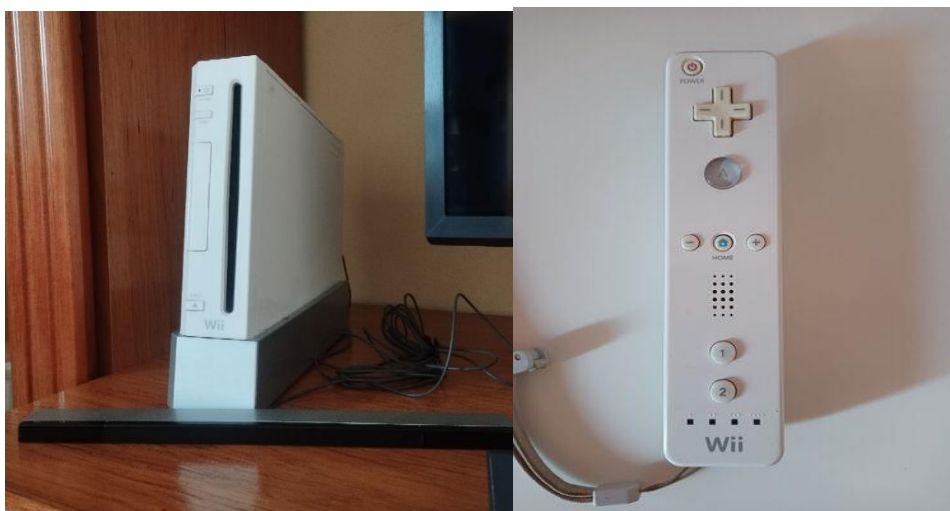
Figura 11. Dispositivo de Realidad Virtual no inmersiva Nintendo Wii. A la izquierda, la consola y el sensor. A la derecha, el control remoto de la consola.
