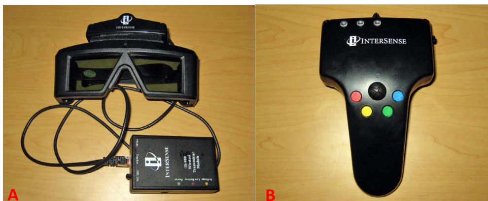
Figura 9. Accesorios de la tecnología CAVE. Figura A: gafas polarizadas con sensor para la cabeza. Figura B: mando.
