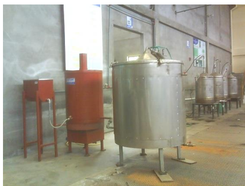
Imagen 0.2. Destilador con capacidad de 60 kg. Tomado de la Planta de Productos naturales de la UTPL.
