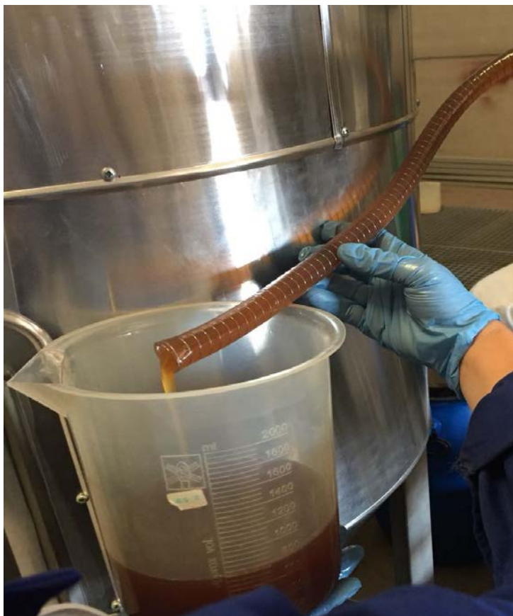
Figura RD10: Medida de los caudales en el reactor.
