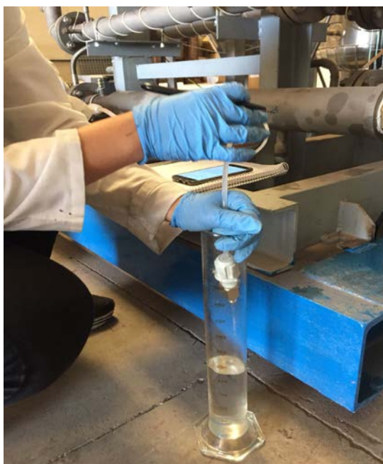
Figura RD9: Medida del caudal de bombas dosificadoras de aceite y mezcla de MeOH-NaOH.
