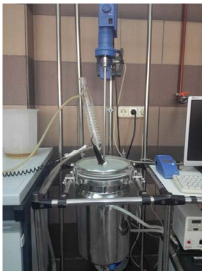
Figura MM24: Reactor tanque agitado discontinuo de 50 L.
