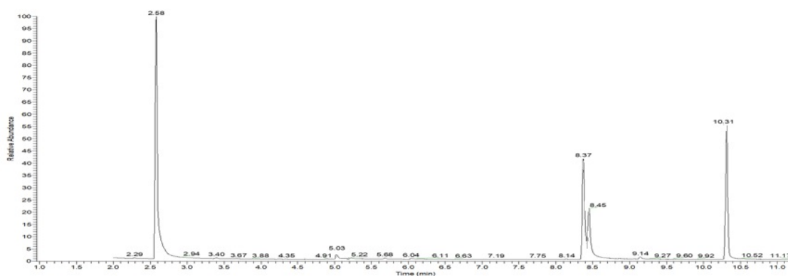
Figura RD 23: Cromatograma de la muestra R-180-30 (aditivo oxigenado producido con AA a 115 °C).
