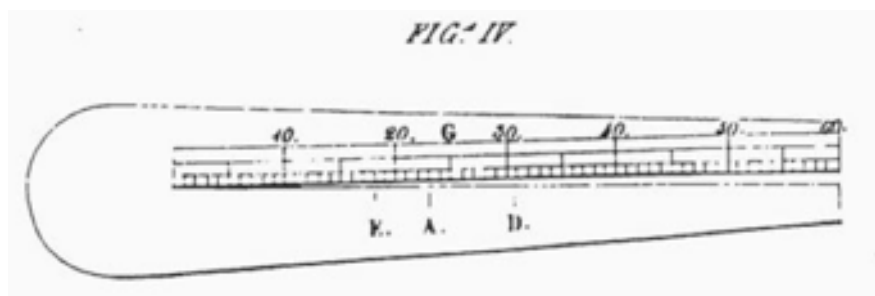
Figura 4. Medidor del calibre de cuerdas. Fuente: Spohr, Ludwig: Violinschule
