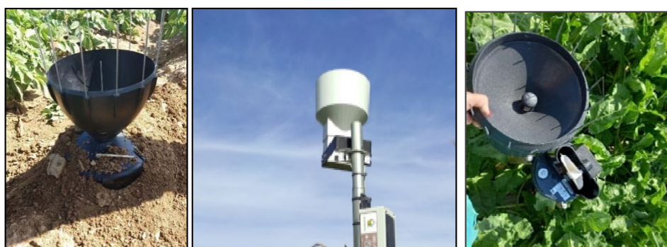
Imágenes 9, 10 y 11. Pluviómetros instalados.
