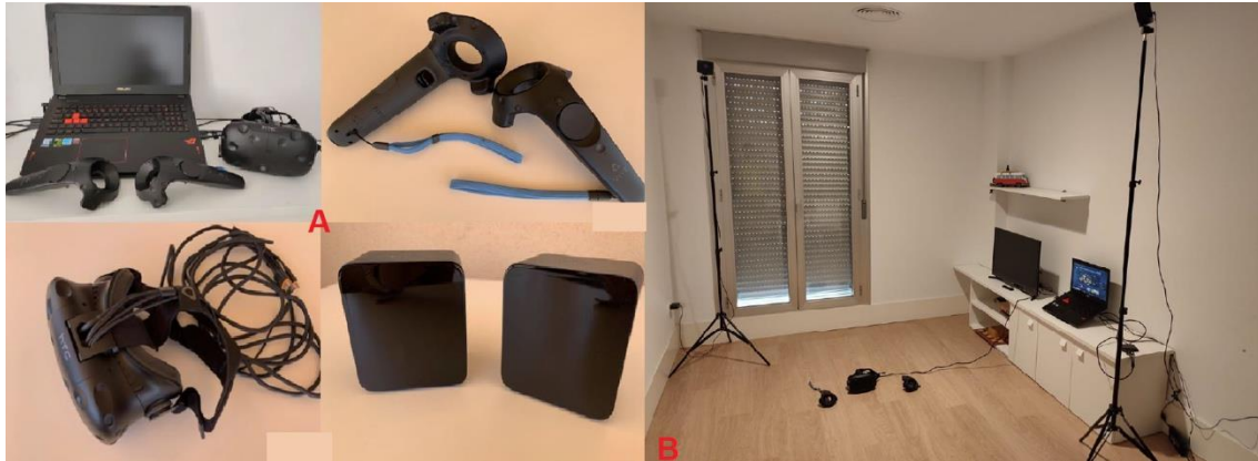
Figura 6. Dispositivo Realidad Virtual Inmersiva HTC Vive (A). Espacio de rehabilitación (habitación virtual), usando el dispositivo HTC Vive (B) Fuente: Elaboración Propia
