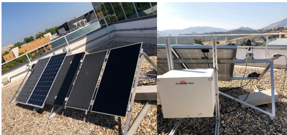
Figura 11 Estructura fija montada en la terraza del CEACTEMA destinada a estudios de soiling .
