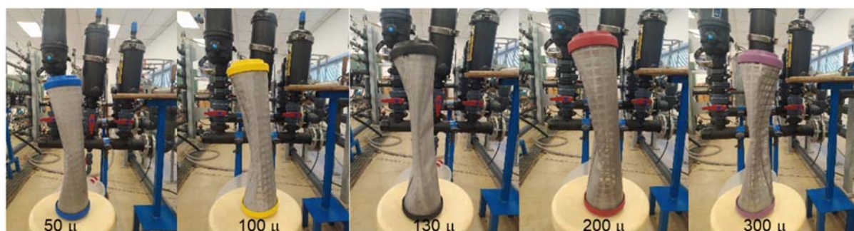
Figura 2. Rotura en filtración del cartucho Marca 1 (flujo exterior – interior).
