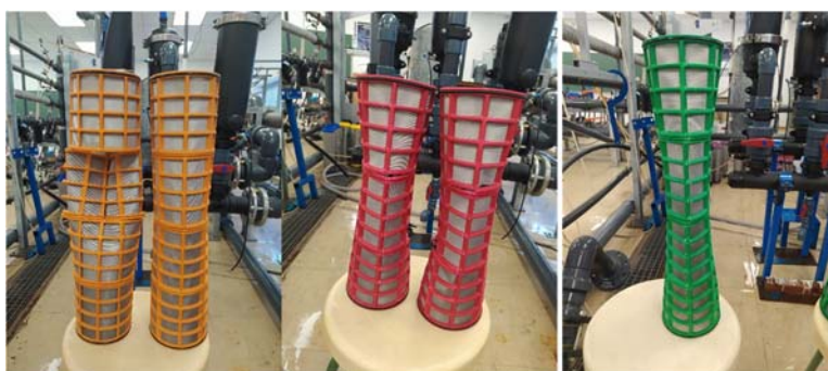
Figura 5. Cartucho de La Marca 2 tras alcanzar la presión de rotura en el proceso de contralavado
