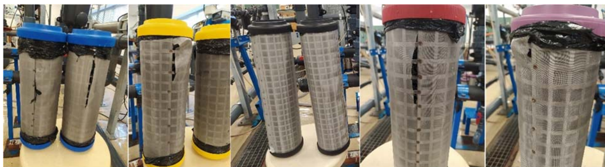
Figura 4. Cartucho de la Marca 1 tras alcanzar la presión de rotura en el proceso de contralavado
