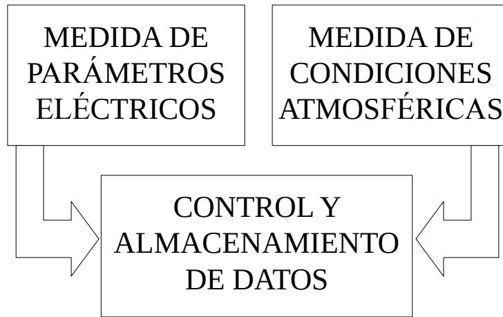
Figura 4.1: Diagrama de bloques resumido del sistema automatizado de medida.
