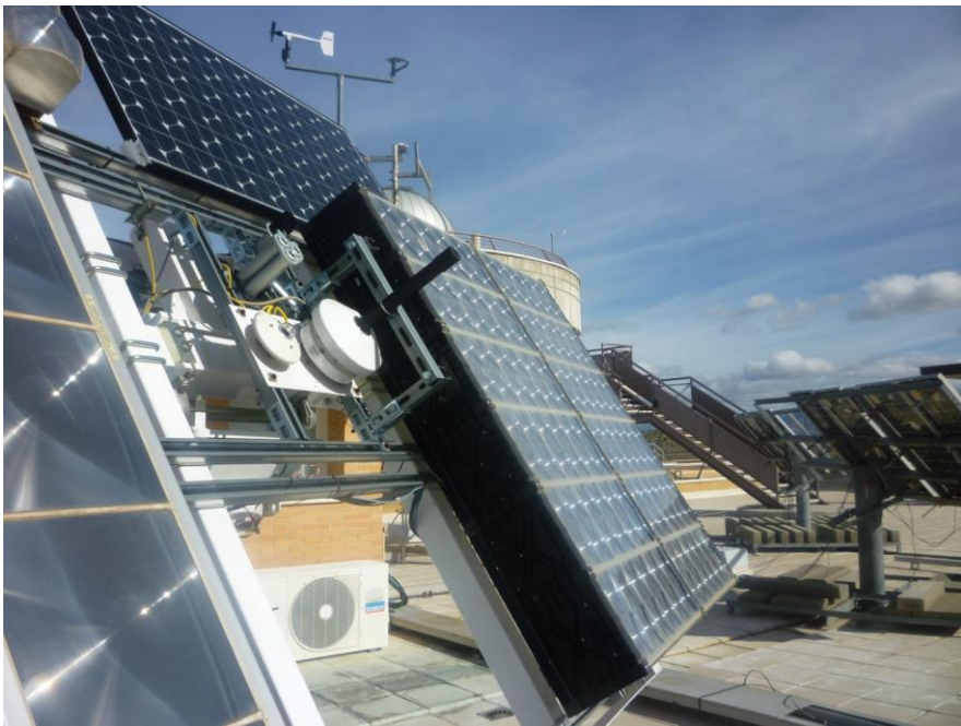
Figura 4.14: Fotografía de los equipos de medida y módulos CPV en terraza.
