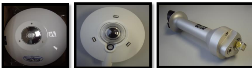
Figura 4.6: (a) Espectro-radiómetro (izquierda), (b) piranómetro (centro) y (c) pirheliómetro (derecha), antes de ser colocados en el seguidor.
