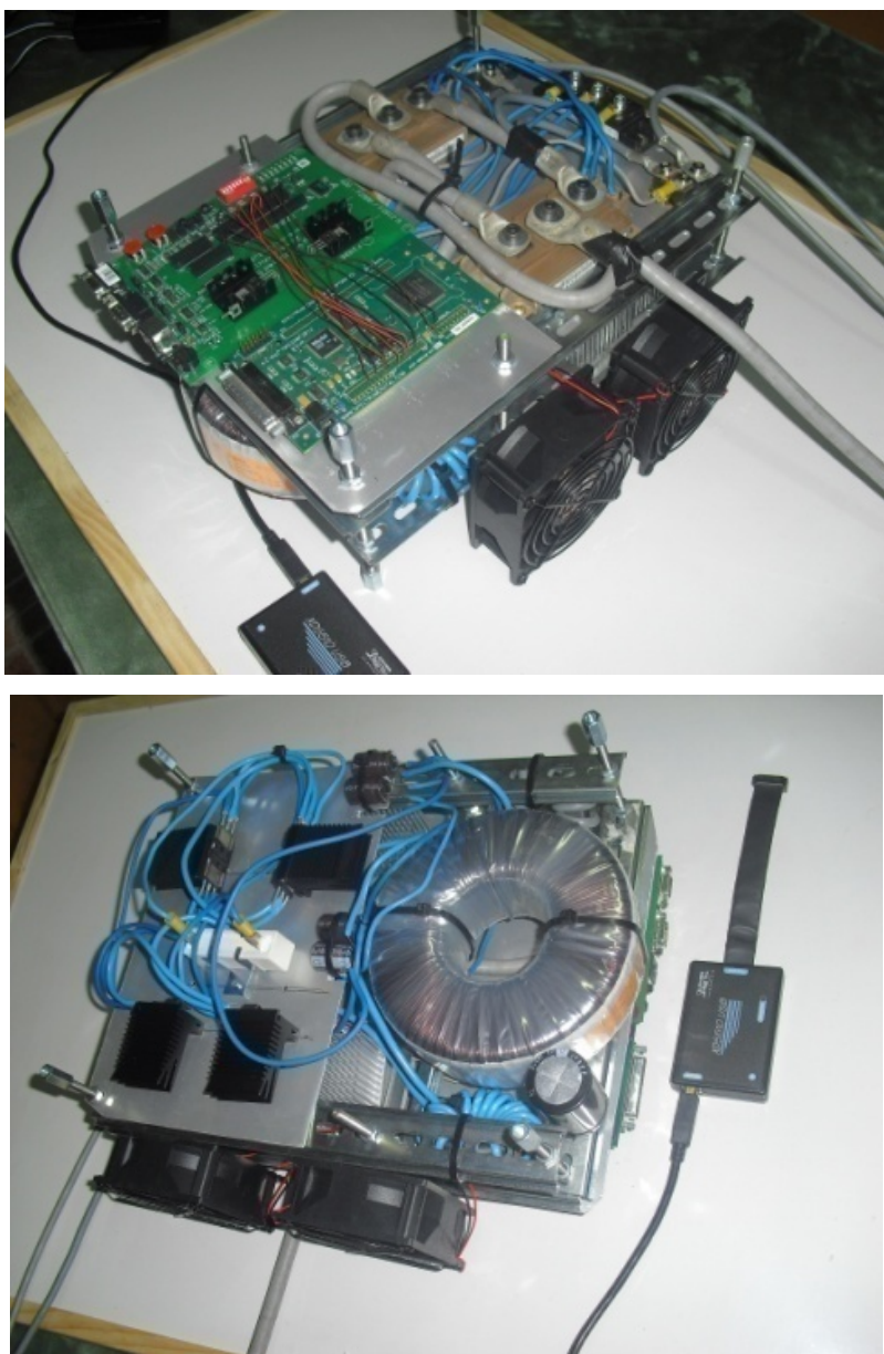
Figura 6.1.15. Prototipo de Laboratorio del convertidor CC/CC bidireccional.
