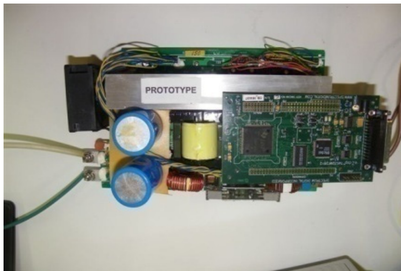
Figura 6.1.13. Prototipo de laboratorio del convertidor CC/CC bidireccional.
