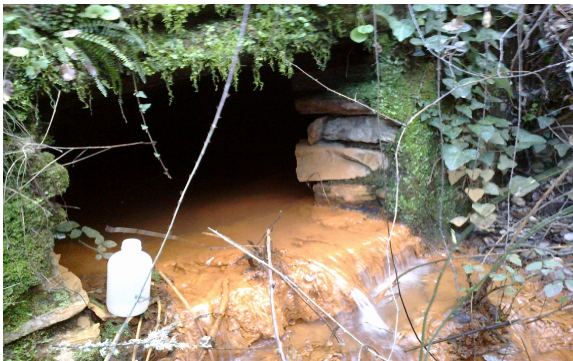
Figura 4.24. Imagen de la bocamina del socavón San Gabriel (AM-2) donde se observan los precipitados de Fe con el típico color anaranjado.
