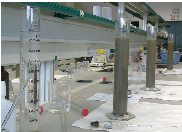
Figura 3.7. Determinación de la textura en los sedimentos de las balsas mediante hidrómetro de Bouyoucos.
