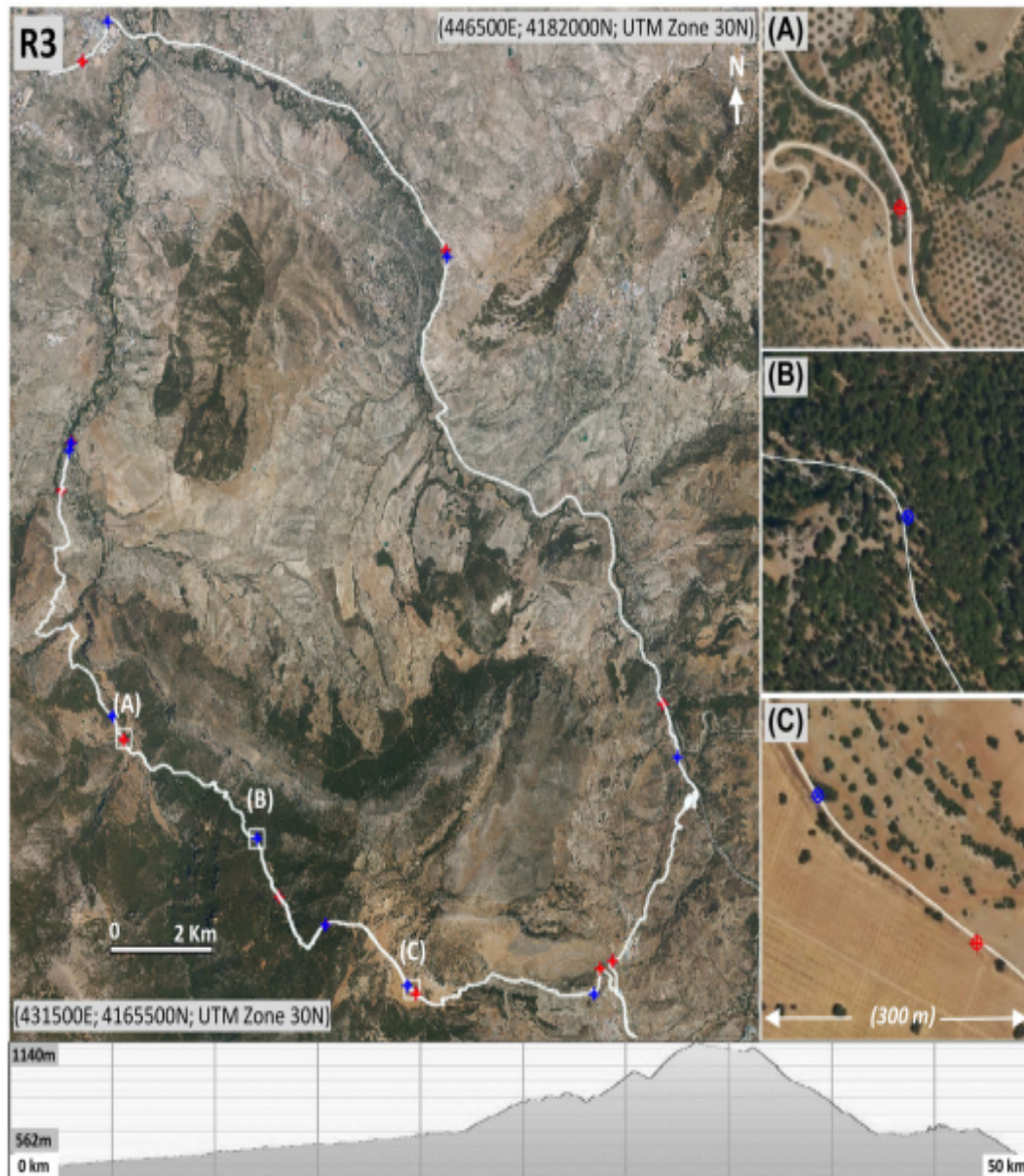
Fig. 33. Definición planimétrica y altimétrica de la ruta R3, en coche (sesión S9), con un receptor de sistemas mundiales de navegación por satélite (GNSS) de bajo coste (LCR; línea blanca), un collar GNSS multifrecuencia (MFC; puntos azules) y un collar GNSS monofrecuencia (SFC; puntos rojos). Realizamos la prueba cinemática C en Jaén, España, el 20 de junio de 2022. Figura parcialmente derivada de ortofotografías del Programa Nacional de Ortofotografía de España PNOA-2019 CC-BY, scne.es.
