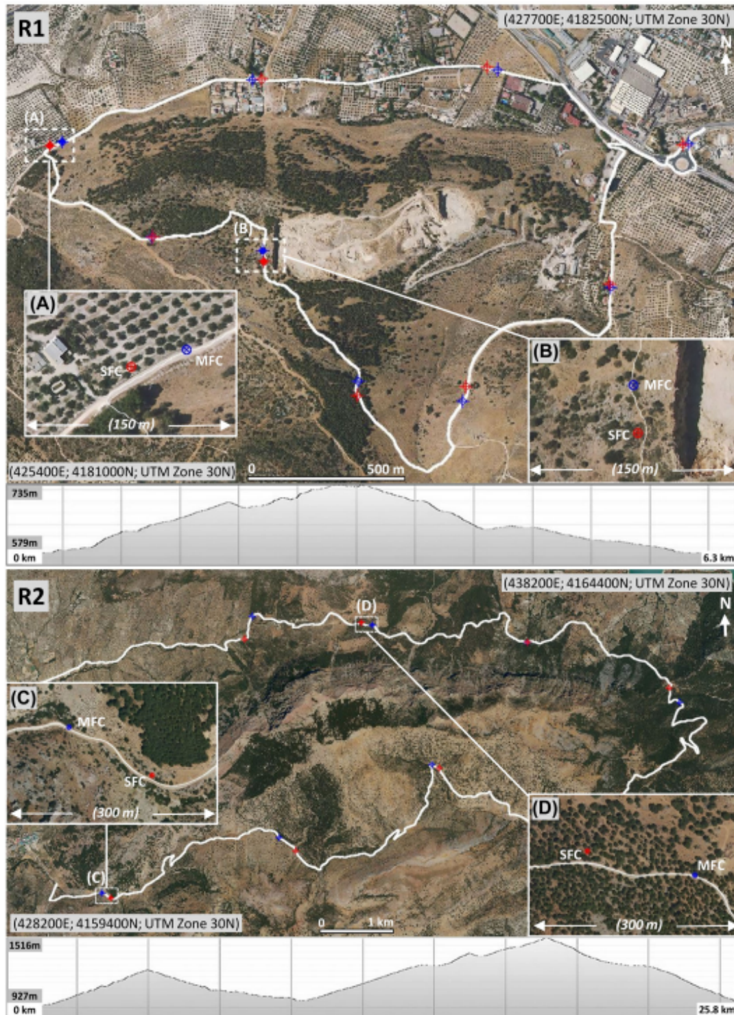
Fig. 32. Definición planimétrica y altimétrica de la ruta R1, a pie (sesión S6), y de la ruta R2, en coche (sesión S7), con un receptor de sistemas mundiales de navegación por satélite (GNSS) de bajo coste (LCR; línea blanca), un collar GNSS multifrecuencia (MFC; puntos azules) y un collar GNSS monofrecuencia (SFC; puntos rojos). Realizamos la prueba cinemática C en Jaén, España, los días 18 y 19 de junio de 2021. Figura parcialmente derivada de ortofotografías del Programa Nacional de Ortofotografía de España PNOA-2019 CC-BY, scne.es.
