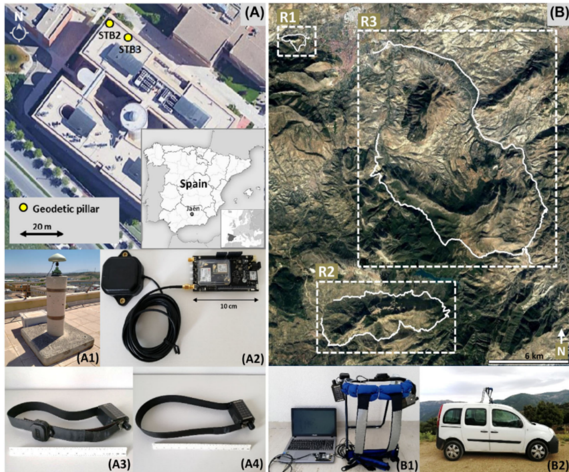
Fig. 28. A) Localización de los pilares geodésicos STB2 y STB3 para el ensayo estático realizado en el Campus de la Universidad de Jaén, España, del 16 al 25 de febrero de 2021 mostrando el receptor y la antena geodésicos del sistema global de navegación por satélite (GNSS) (A1), el receptor GNSS de bajo coste y la antena de parche activo (LCR; A2), el collar GNSS multifrecuencia (MFC; A3) y el collar GNSS monofrecuencia (SFC; A4). B) Rutas R1, R2 y R3 para la prueba cinemática realizada en Jaén, España, en junio de 2021 y 2022 mostrando el equipo para la ruta R1 (LCR, MFC y SFC, ordenador portátil y mochila; B1) y equipo y vehículo para las rutas R2 y R3 (B2).
