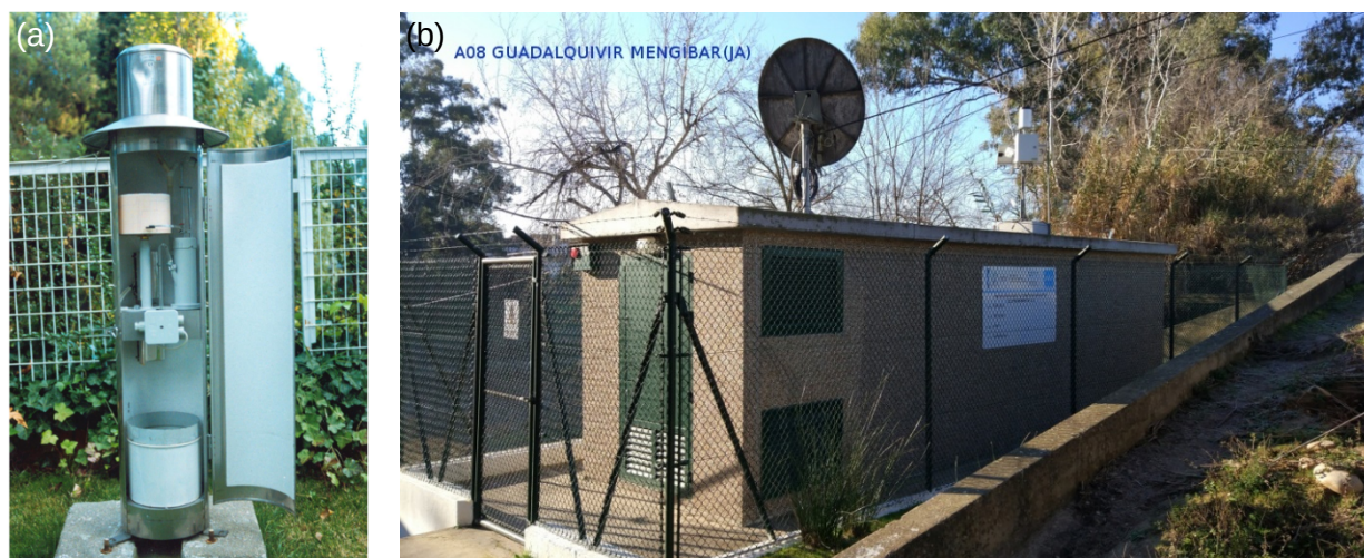
Figura 23. (a) Detalle de un pluviógrafo de sifón usado por la Agencia Estatal de Meteorología (AEMET) en su red manual. (b) Pluviómetro automático VSAT de balancín A08 “Guadalquivir Mengíbar” perteneciente a la red SAIH Guadalquivir.
