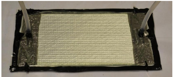
Figura 90. Montaje de bolsa de vacío utilizado para la infusión de laminados [+45,-45]_s reforzados con stitching y sin refuerzo. Fuente: elaboración propia.
