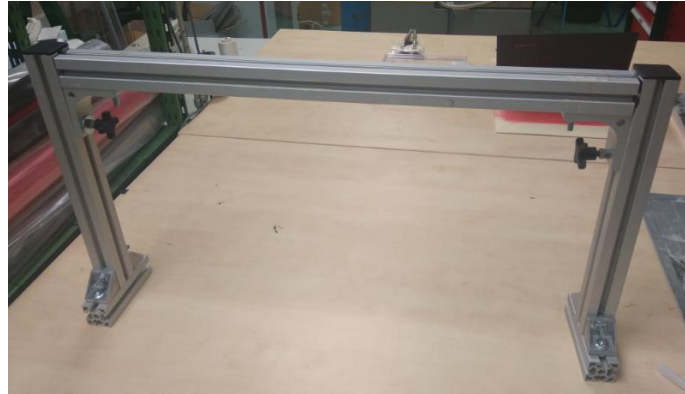
Figura 69. Estructura de soporte de la cámara, que permite situarla en la posición XYZ más adecuada en función del laminado. Fuente: elaboración propia.
