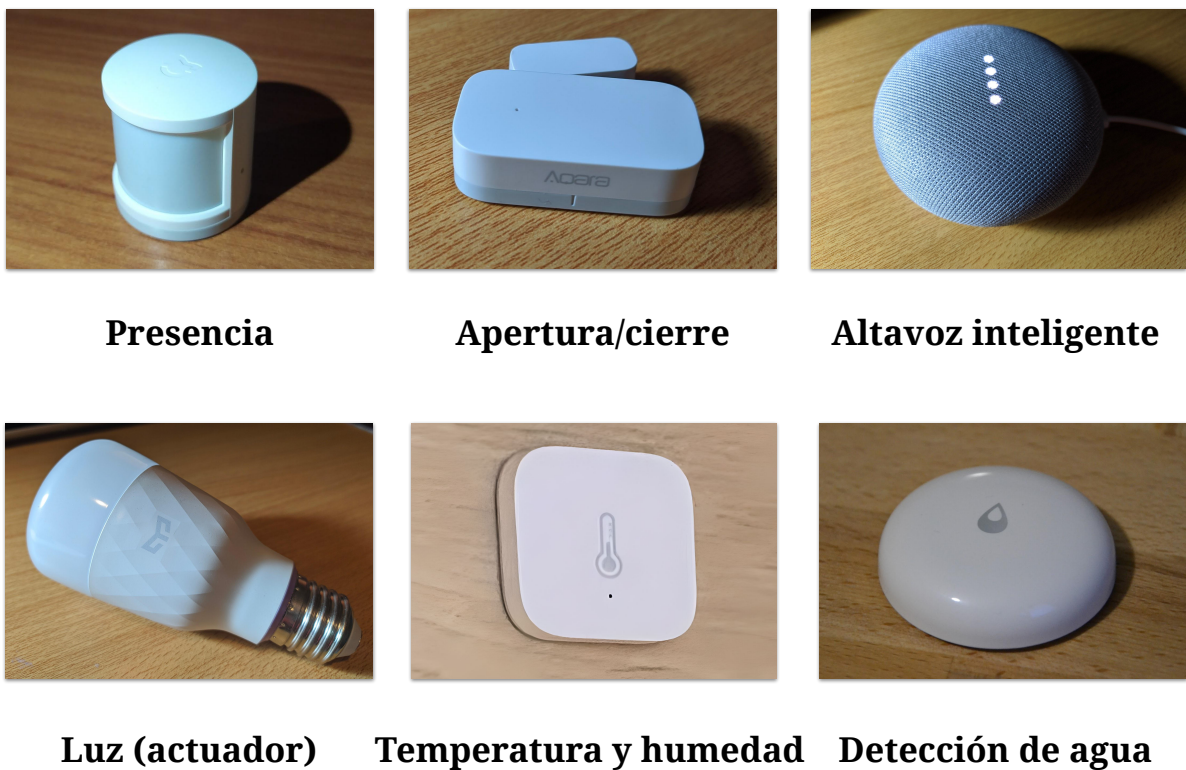
Figura 3.2: Sensores y actuadores comerciales integrados en el sistema Mercedes a través de HA.
