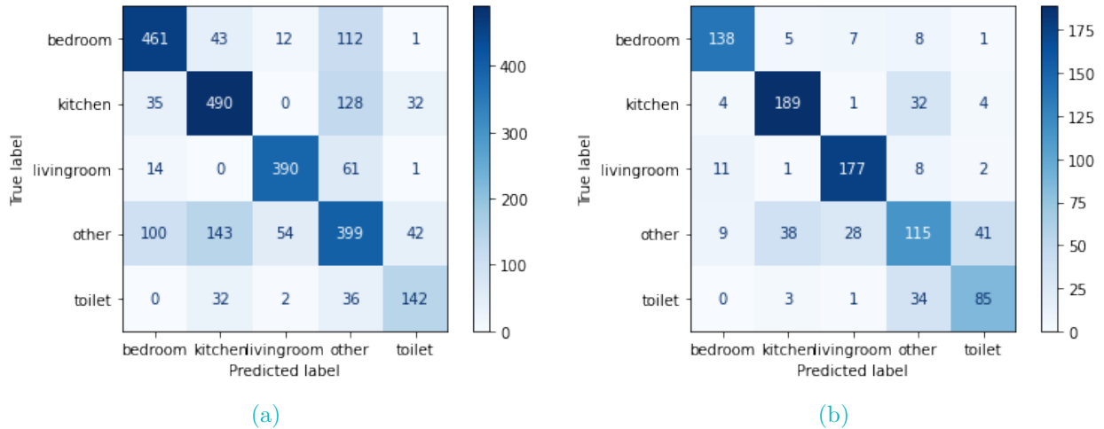
Figura 4.7: Precisión de la posición de los habitantes en las habitaciones a partir de los datos de RSSI de BLE en los pisos A y B.
