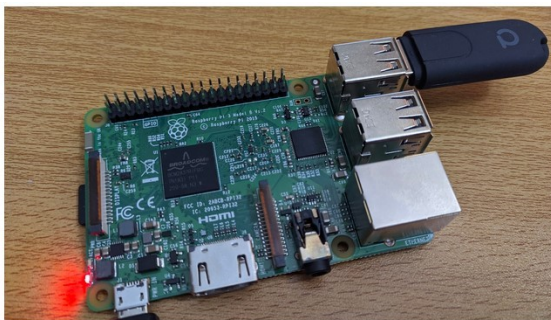
Figura 3.5: Raspberry Pi y Conbee II para integración de sensores con protocolo ZigBee en HA.
