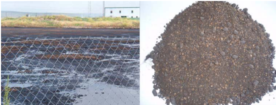
Figura 2.13. Foto de balsa de orujo en extractoras (izquierda) y orujillo resultante tras su secado (derecha).
