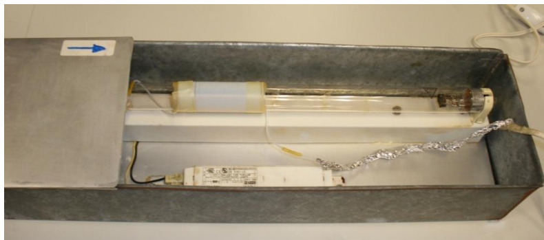
Fig. II.5. Fotorreactor preparado para su implementación en sistemas en flujo
