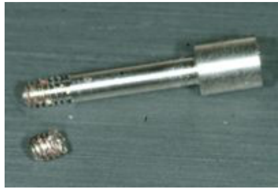
Figura 23. Fractura tercio coronal de un implante y de tornillo del pilar protésico. www.facialart.com
