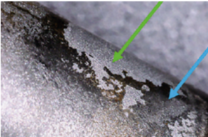
Figura 14. Producto de corrosión en superficie de titanio expuesta al medio biológico. Orthotreams.Wordpress.
