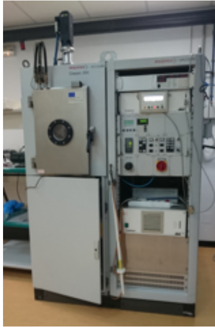
Figura 67. Cámara de evaporación de alto vacío donde se recubrieron tornillos experimentales. Facultad de CC. Químicas .UCM. Fuente Propia.
