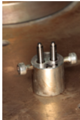
Figura 68. Colocación tornillos protéticos experimentales previo a su tratamiento. Fuente propia.
