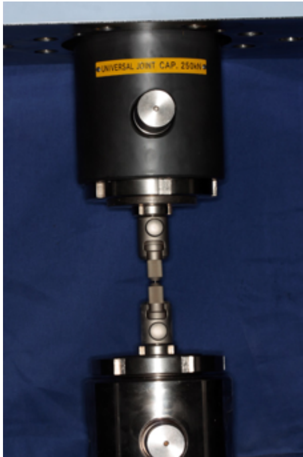
Figura 72. Máquina universal de ensayos Shimadzu con útiles específicos para ensayar los tornillos protéticos. EPS Linares. Fuente propia.
