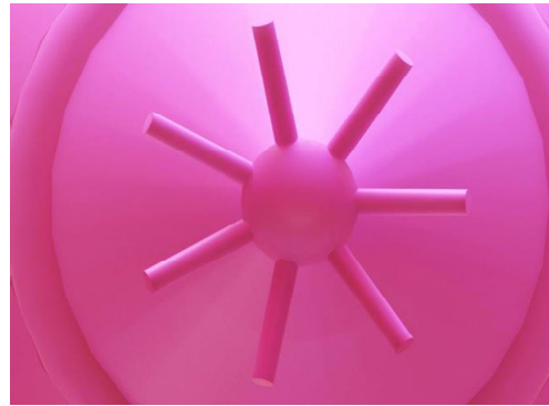
Figura 18. Modelo 3D del molde de silicona de la boquilla del inyector obtenido vía Solidworks
