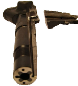
Figura 8. Corte en el cuerpo del inyector
