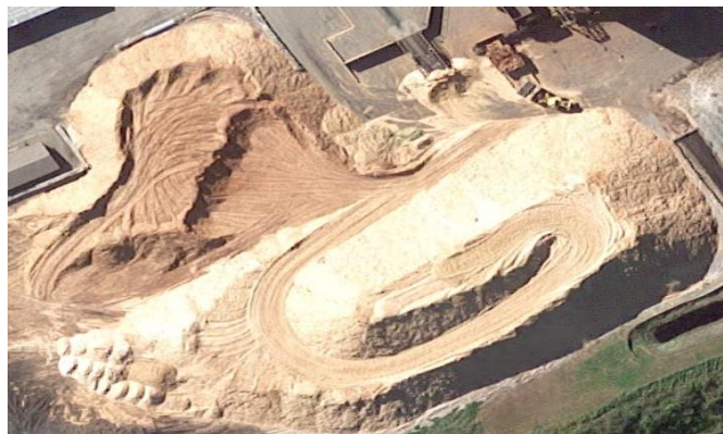
Imagen 15.- Aplicación del método de Pila Única utilizando rampa. [Biomass Magazine, 2017]
