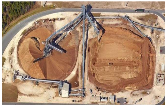
Imagen 14.- Aplicación del método Mo-Do y del Método de Pila Única en una misma planta. [Biomass Magazine, 2017]
