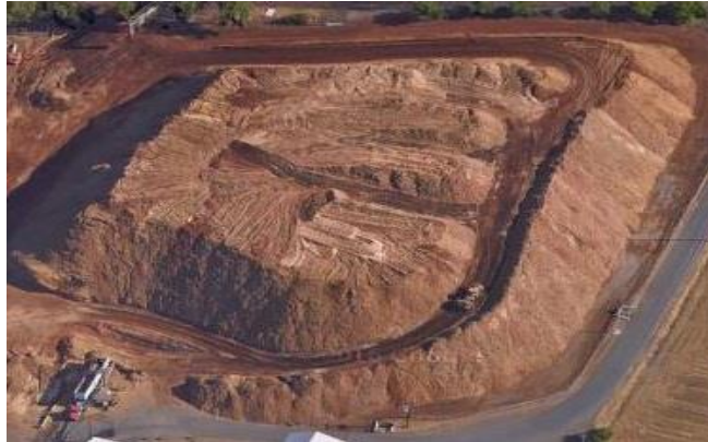
Imagen 16.- Aplicación del método de Pila Única utilizando rampas. [Biomass Magazine, 2017]
