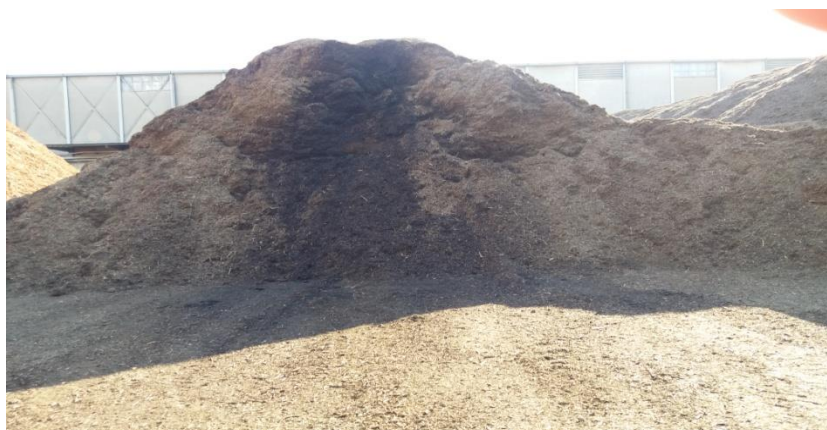
Imagen 2.- Acopio de biomasa donde se observa la zona de calentamiento del acopio por la circulación del aire. [Fuente: Elaboración Propia]
