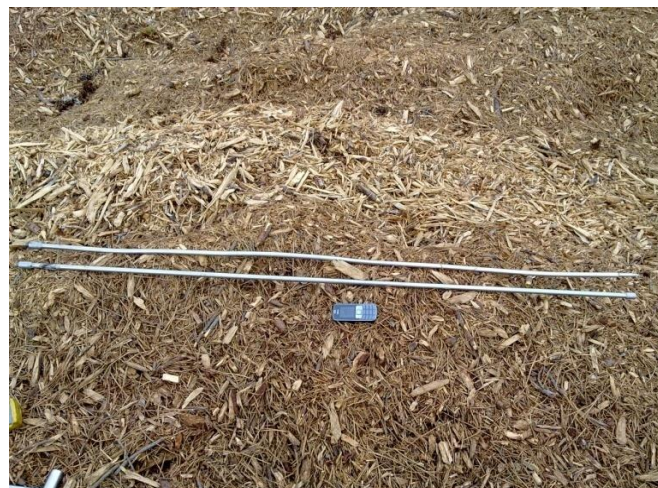
Imagen 26.- Sonda de temperatura colocada en la superficie de un acopio de pino. [Fuente: Elaboración Propia]
