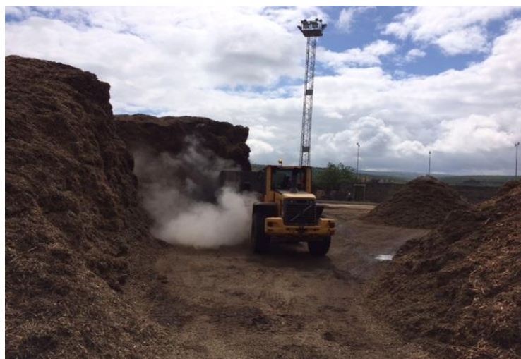
Imagen 34.- Actuación sobre foco caliente en acopio de poda de olivo. [Fuente: Elaboración Propia]
