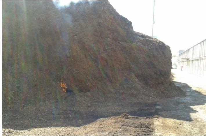
Imagen 31.- Foco caliente que combustiona al ponerse en contacto con el oxígeno. [Fuente: Elaboración Propia]
