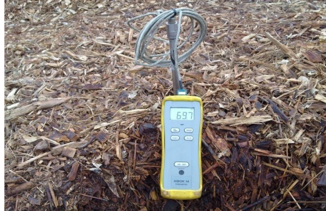
Imagen 27.- Termómetro digital midiendo la temperatura en un punto caliente de un acopio de pino. [Fuente: Elaboración Propia ]
