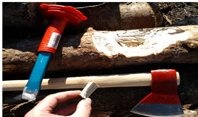
Imagen 57.- Toma de muestras de tronco con hacha. [Fuente: Elaboración Propia]
