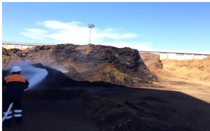
Imagen 52.- Utilización de Sistema Contra Incendios para refrigerar el acopio. [Fuente: Elaboración Propia]
