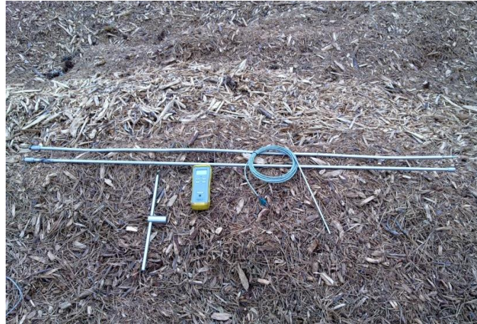
Imagen 21.- Lanzas de acero inoxidable para la medición de la temperatura en el interior de acopios de madera con sonda PT-100. [Fuente: Elaboración Propia ]
