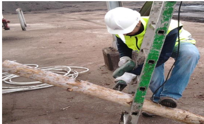
Imagen 56.- Corte de rodaja con motosierra. [Fuente: Elaboración Propia]
