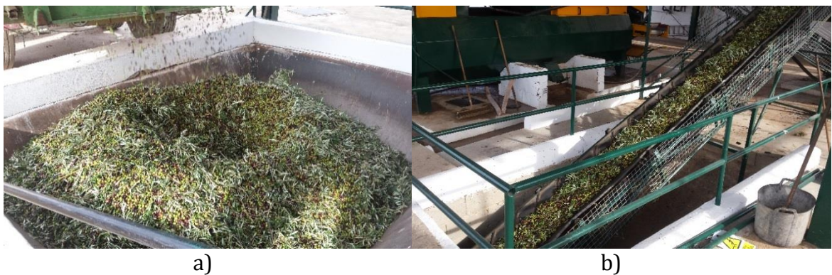
Figura 2.15. a) Tolva de recepción; b) Cinta transportadora
