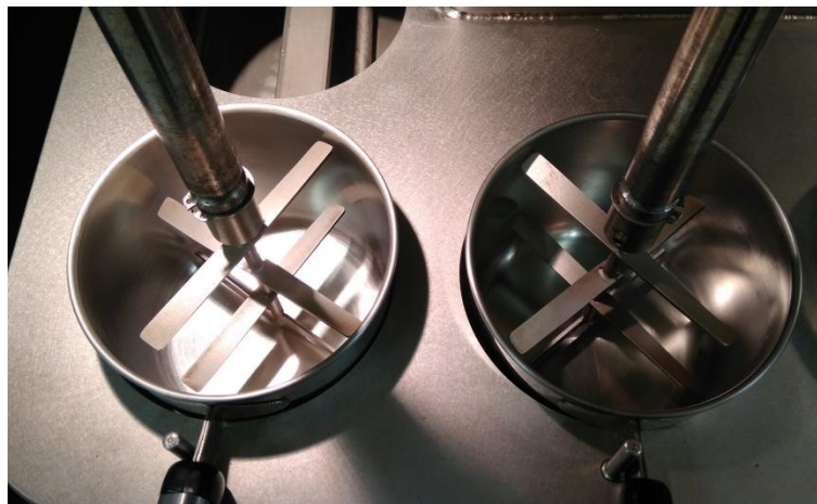
Figura 2.30. Detalle del cazo y las paletas de la termobatidora
