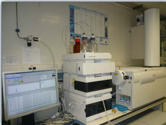
Figura III.7. Equipo de cromatografía de líquidos/espectrometría de masas con analizador de tiempo de vuelo (GC-TOF-MS) utilizado para el análisis de contaminantes emergentes (artículos científicos 4 y 5). Grupo de investigación de Química Analítica (FQM-323), Universidad de Jaén.
