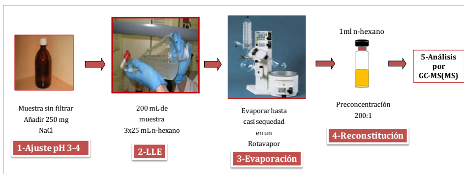
Figura III.1. Esquema del procedimiento de extracción líquido-líquido previo análisis del multiresiduo de sustancias prioritarias por GC-MS(MS).
