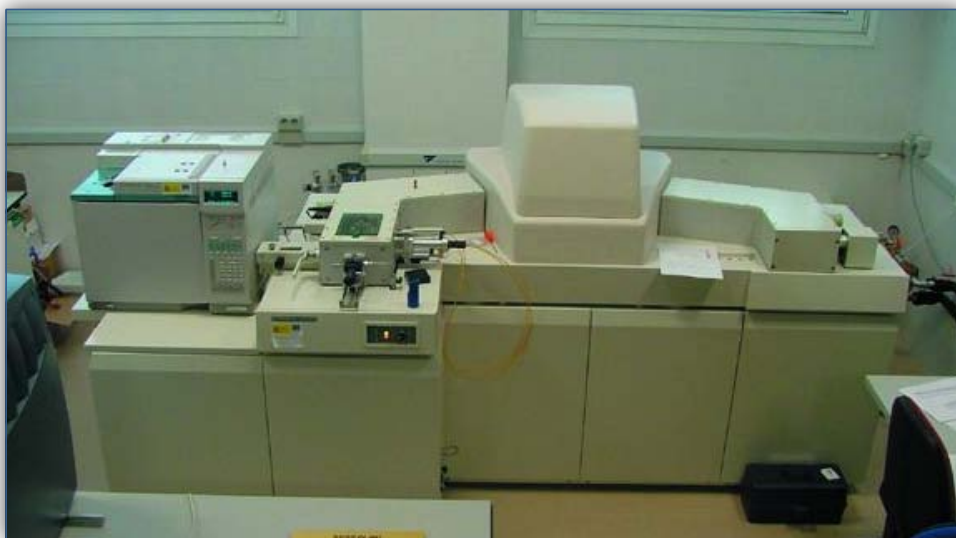
Figura III.5. Equipo de cromatografía de gases/espectrometría de masas con analizador de sector magnético de alta resolución (GC-HRMS) utilizado para el análisis de contaminantes prioritarios (artículo científico 1). Centro de instrumentación científico-técnica, Universidad de Jaén.
