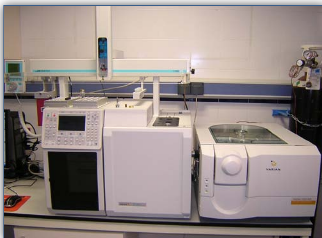
Figura III.6. Equipo de cromatografía de gases/espectrometría de masas con analizador de triple cuadrupolo (GC-QqQ-MS) utilizado para el análisis de contaminantes prioritarios (artículos científicos 2 y 3). Grupo de investigación de Química Analítica (FQM-323), Universidad de Jaén.
