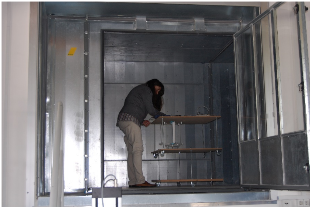
Fig. 104 Lay-out de la maqueta S-VAWT pequeña en el túnel de viento del laboratorio de ZEL-EN (Krsko-Eslovenia) 135
