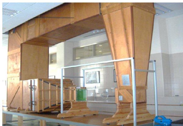
Figura 2: Túnel de viento (tipo cerrado) de la Escuela Politécnica Superior de Jaén, laboratorio de fluidos.
