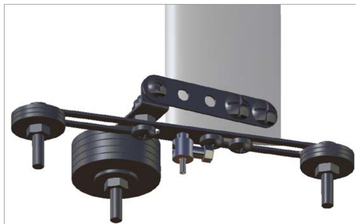
Fig. 84. Detalle renderizado del contrapeso adaptado para regular el Centro de Gravedad. Configuración 1b_CG BAL 3p-3p 30gr-blades 5gr-washer 119
