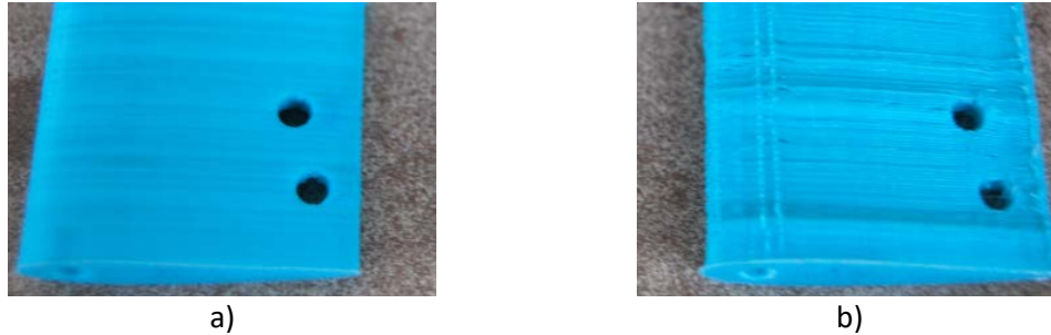
Fig. 62. Partes de álabes impresos en PLA, en impresora BCN3D con diferente altura de capa: 0.2mm; (b) 0.4mm
