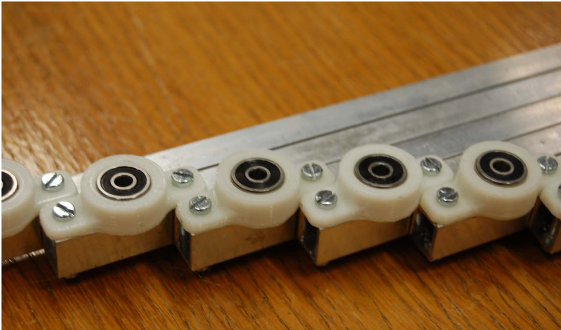
Fig. 98. Detalle del montaje de los pequeños rodamientos (624 EE) que permiten la rotación tipo Pitch de los álabes de 16 cm de cuerda
