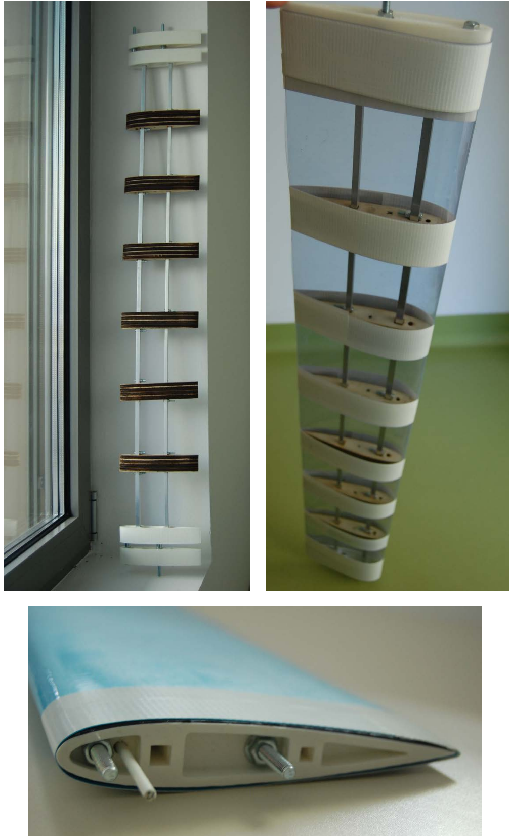
Fig. 66. Imágenes del álabe de 16 cm de cuerda, 108 cm de esbeltez y masa total 1165gr. Fases de ensamblado, refuerzo con acetato y laminado final 100
