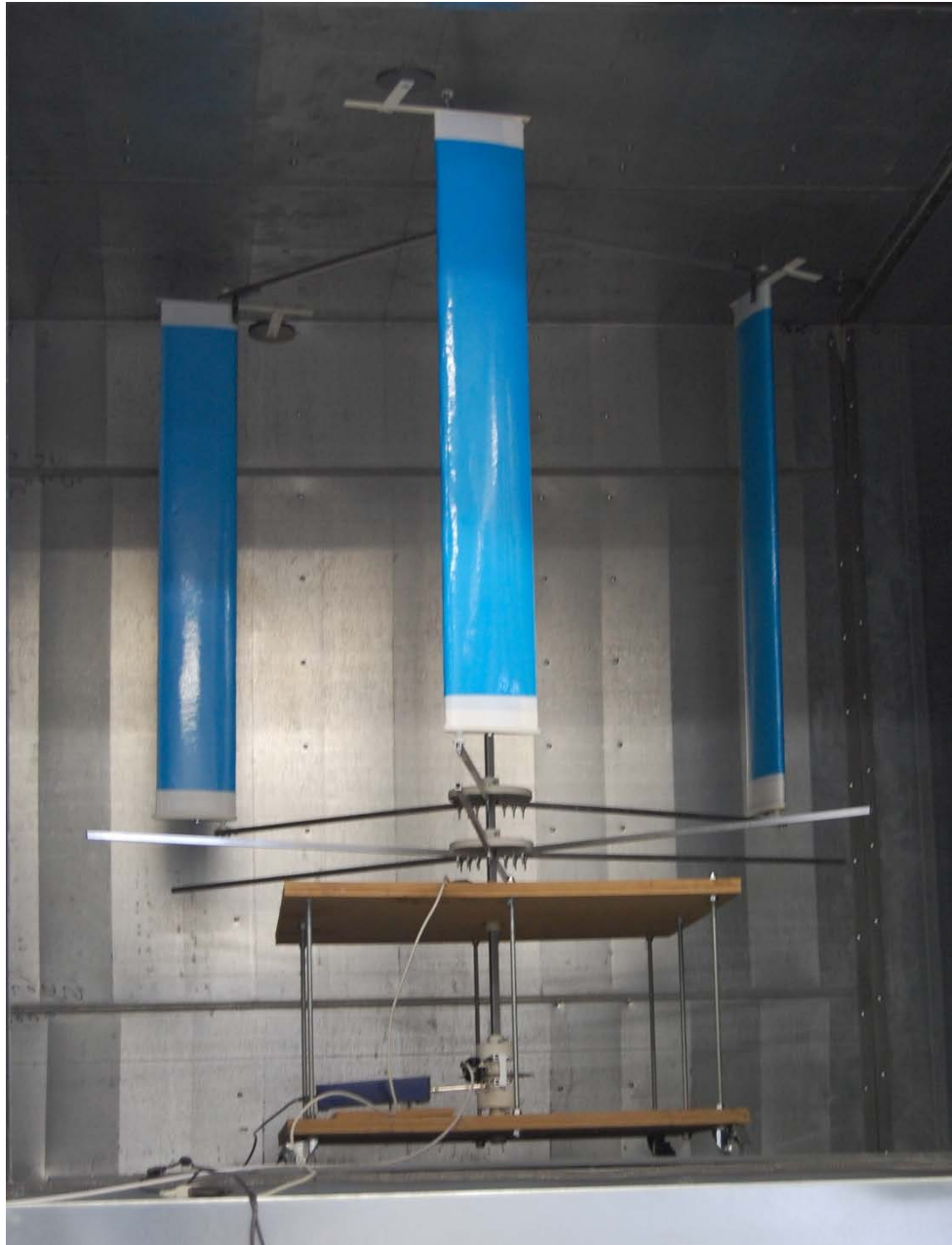
Fig. 99. Turbina de 1.6 m de diámetro durante pruebas realizadas en el túnel de viento de ZEL-EN, situado en Krsko (Eslovenia). Modelo S-VAWT con regulación centrífuga del Pitch 128
