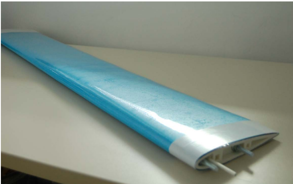
Fig. 95. Resultado del álabe de 16 cm de cuerda y 108 cm de esbeltez, una vez finalizada su fabricación y montaje 125
