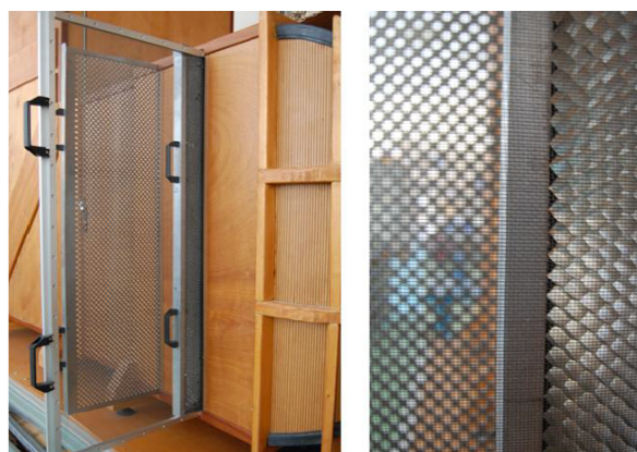
Figura 4: Rejillas con configuración de panel de abeja, que reducen la turbulencia del flujo de aire.
