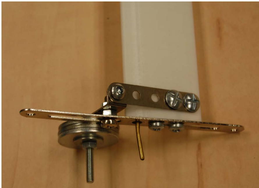
Fig. 89. Detalle del montaje del contrapeso modificado para ensayar en túnel de viento el efecto de las variaciones del Centro de Gravedad de la Tab. 16
