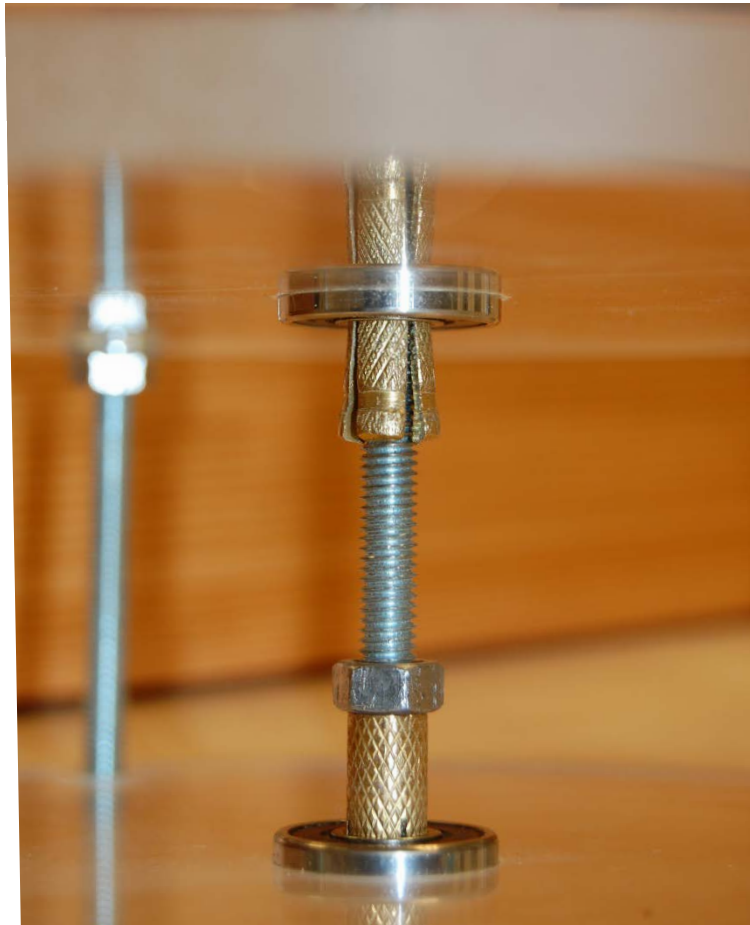
Fig. 90. Detalle de los rodamientos (608.2RS) de la maqueta de 16 cm de diámetro
