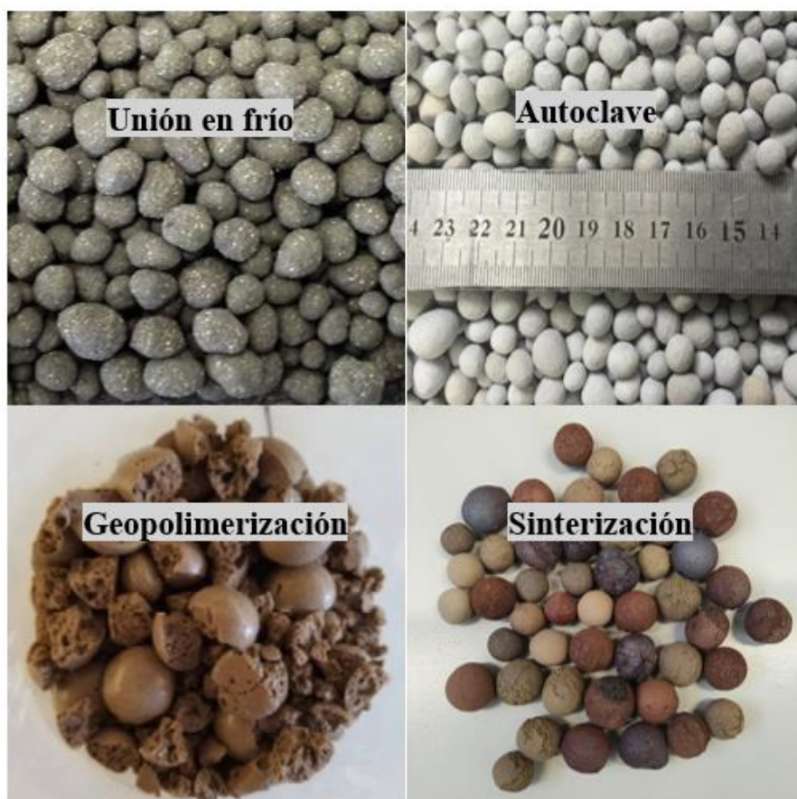
Figura 1.8. Métodos de fabricación de LWAs: unión en frío (Tuncel y Pekmezci, 2018), autoclave (Wang et al., 2020), geopolimerización (Peyne et al., 2018) y sinterización (áridos obtenidos durante esta Tesis Doctoral).
