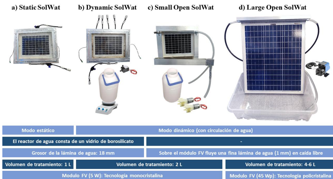
Figura 7.1. Prototipos a escala de laboratorio durante el desarrollo de la tecnología SolWat: a) Static SolWat, b) Dynamic SolWat, c) Small Open SolWat y d) Large Open SolWat.
