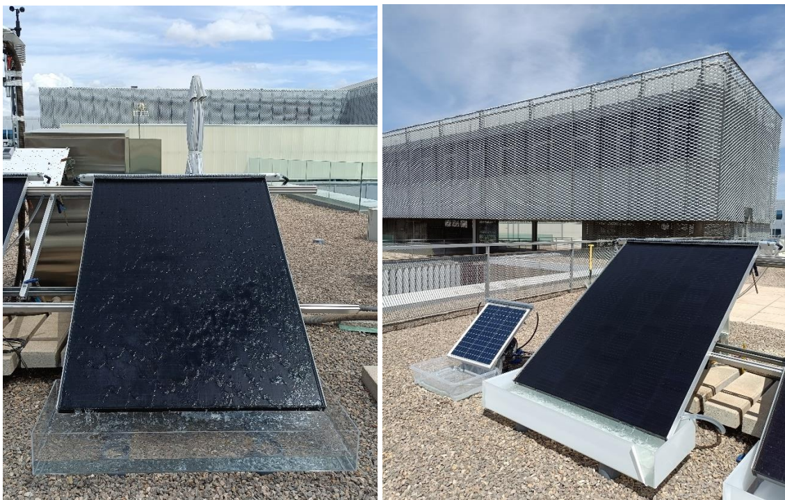
Figura 8.1. Avance en el desarrollo de la tecnología SolWat con el nuevo prototipo Open SolWat en modo dinámico fabricado a mayor escala, con módulos fotovoltaicos comerciales de conexión a red, vs. el prototipo Large Open SolWat.
