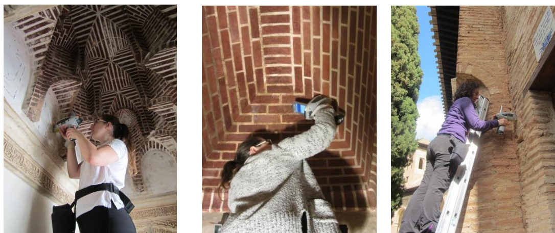
Figura 15 Ejemplos del trabajo de medidas in situ con ED-XRF en diferentes localizaciones de la Alhambra.
