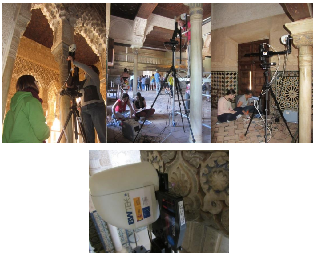
Figura 18 Ejemplos de medidas in situ con espectroscopía Raman portátil en diferentes localizaciones de la Alhambra
