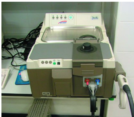
Figura 4.3–31. Espectrómetro FT-NIR Antaris de Nicolet.
