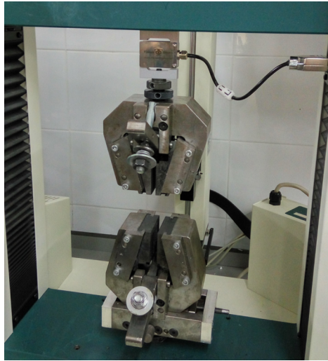
Figura 4.3-12. Sistema de garras con desplazamiento relativo del plano de sujeción.
