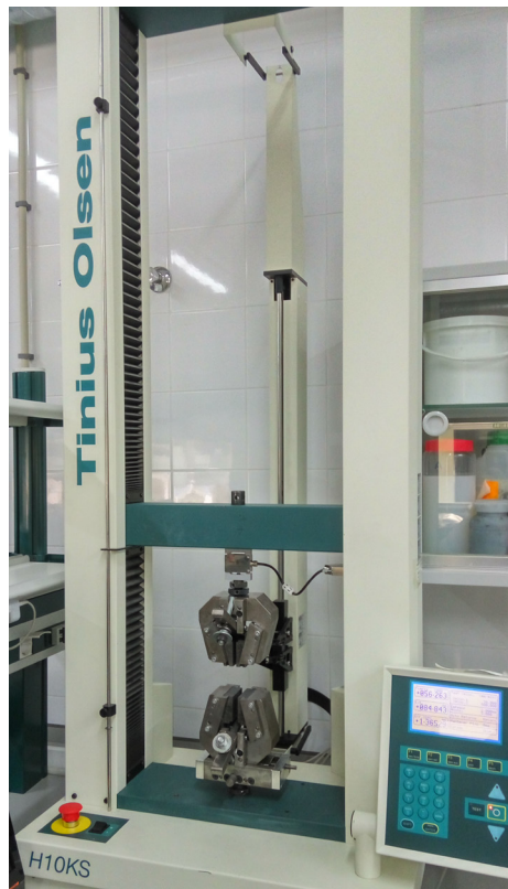
Figura 4.3–11. Máquina Universal de Ensayos Tinius Olsen H10KS.
