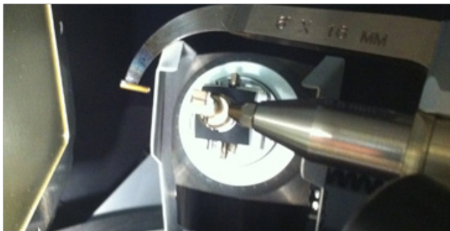
Figura 4.3-34. Muestra dentro del equipo de RXD2D
