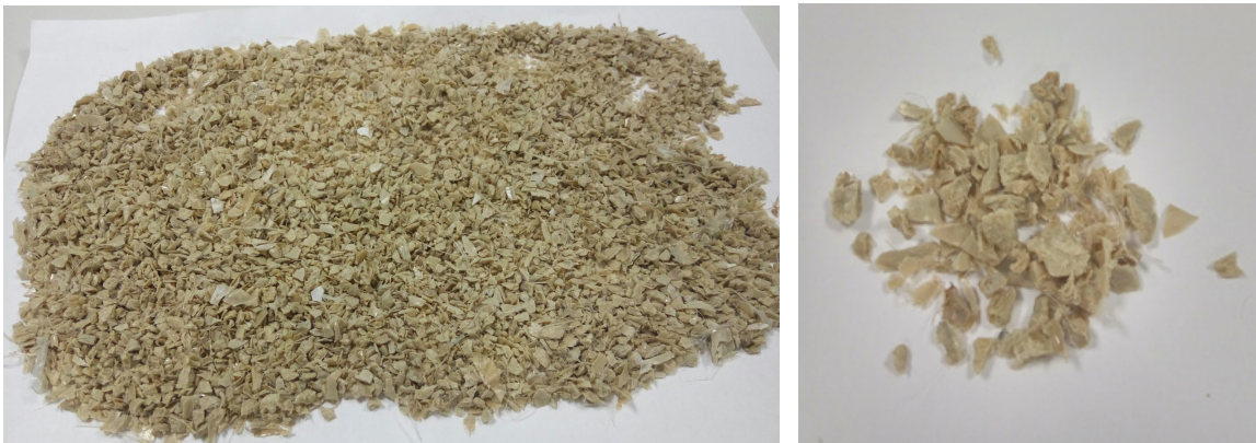
Figura 4.2-8. A la izquierda, granza de PA6 - S - 5+A después del proceso de picado. A la derecha, granza final de PA6-S-5+A después del proceso de tamizado.
