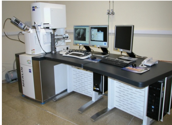
Figura 4.3–29. Equipo FESEM MERLIN de Carl Zeiss.
