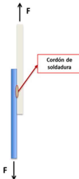
Figura 4.3-13. Esquema de ensayo de resistencia a la cizalladura.
