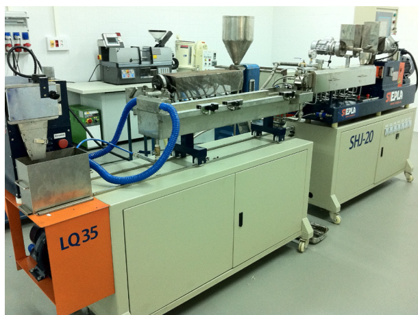
Figura 4.2-1. Línea de extrusión-granceado SHJ-20.
