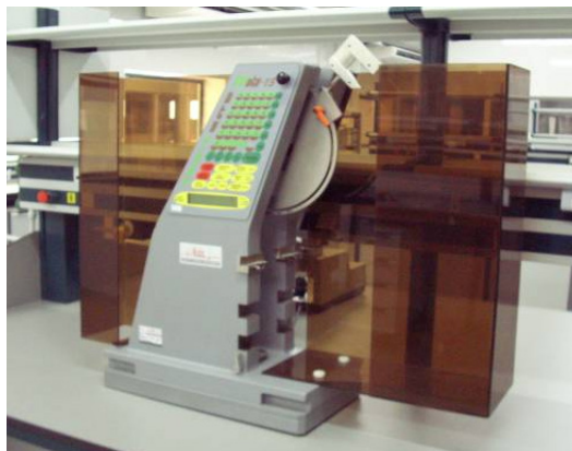
Figura 4.3-10. Impactómetro Charpy-Izod IMPats 15.
