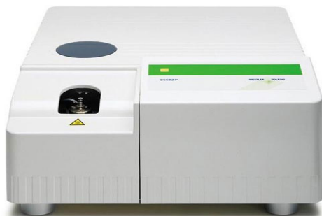
Figura 4.3-22. Equipo DSC 822e Mettler Toledo
