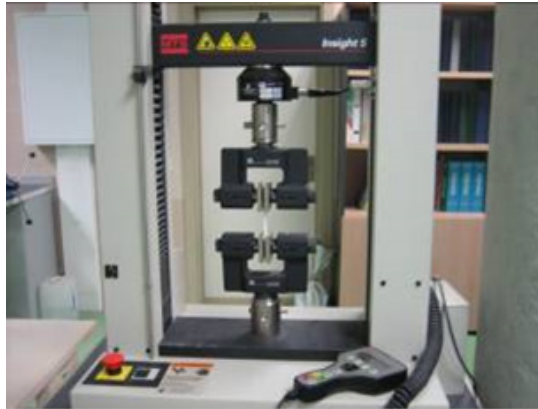
Figura 4.3-8. Equipo de tracción MTS Insight™.
