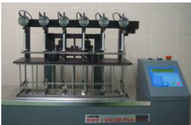
Figura 4.3-24. Equipo de ensayos HDT/VICAT Plus de Davenport
