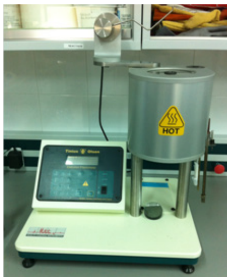
Figura 4.3–26. Plastómetro de extrusión MP600 (Tinius Olsen, Noruega).
