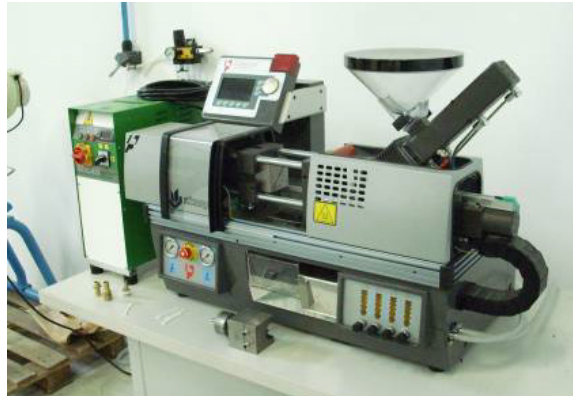
Figura 4.2–10. Equipo de inyección BABYPLAST 6/10P.
