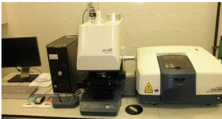
Figura 4.3–32. Microscopio FT-IR multicanal IRT-7000 de Jasco equipado con un espectrómetro FTIR-6300.
