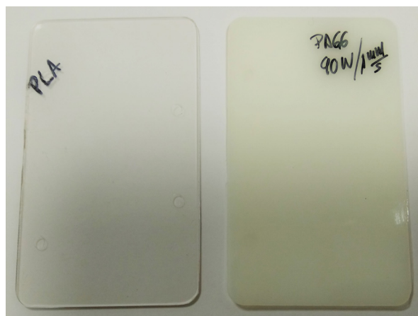
Figura 5.2-5. Resultado de soldadura láser entre PA66 pura y PLA.
