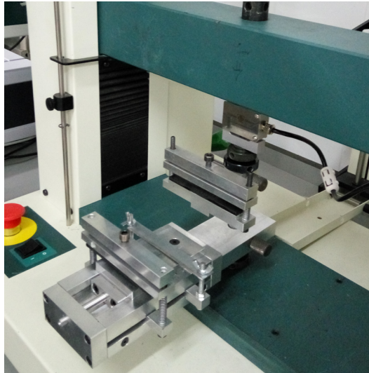
Figura 4.3-16. Utillaje para la realización del ensayo de despegado.
