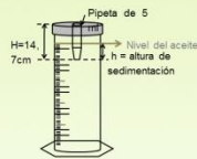
Figura 1: Esquema de la probeta utilizada en el ensayo de decantación estática en el laboratorio.
