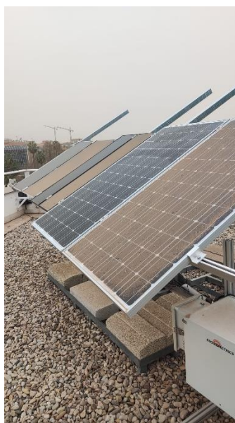
Fig. 9. Instalación experimental para el estudio de las pérdidas por soiling en módulos FV de distintas tecnologías.
